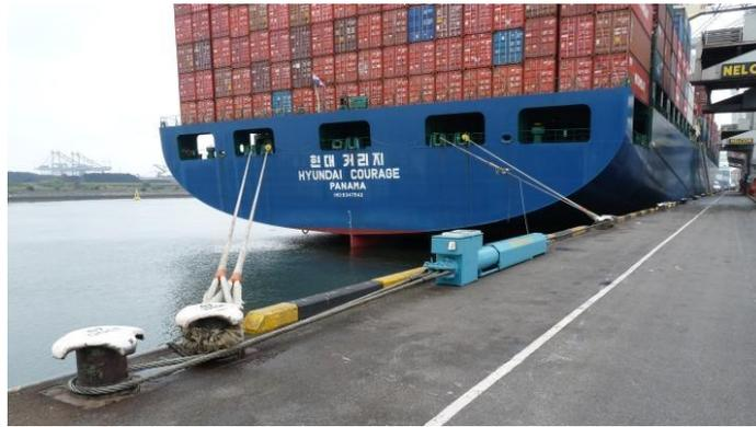
Figura 2.3.1.2 Sistema shoretension
