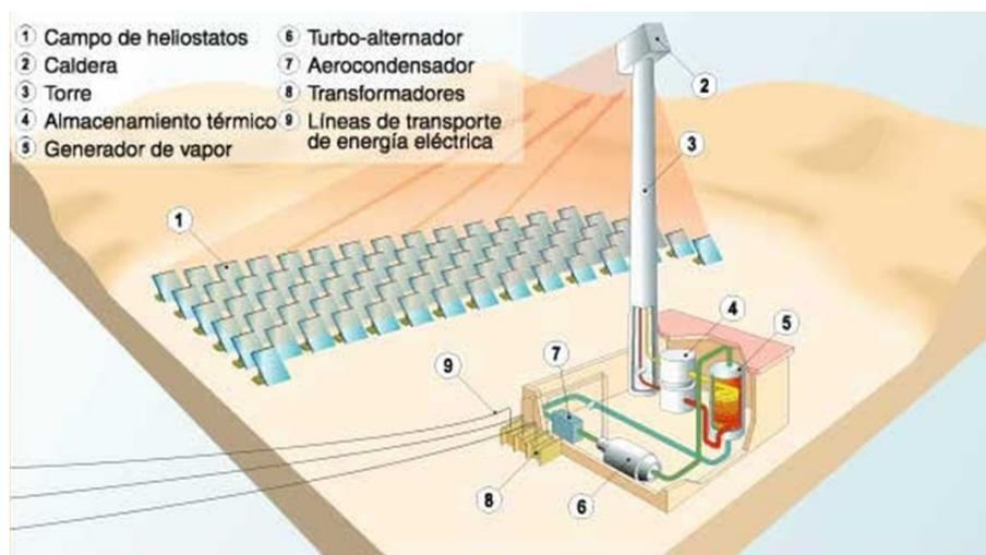
Figura 9 – Partes de una central solar fotovoltaica con heliostatos.
