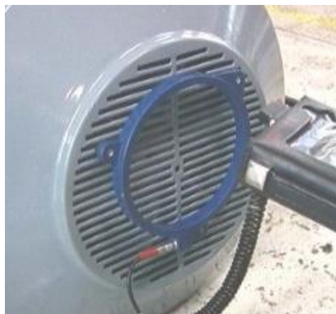
Figura 6 Medidos de flujo magnético utilizado durante una toma de medidas
