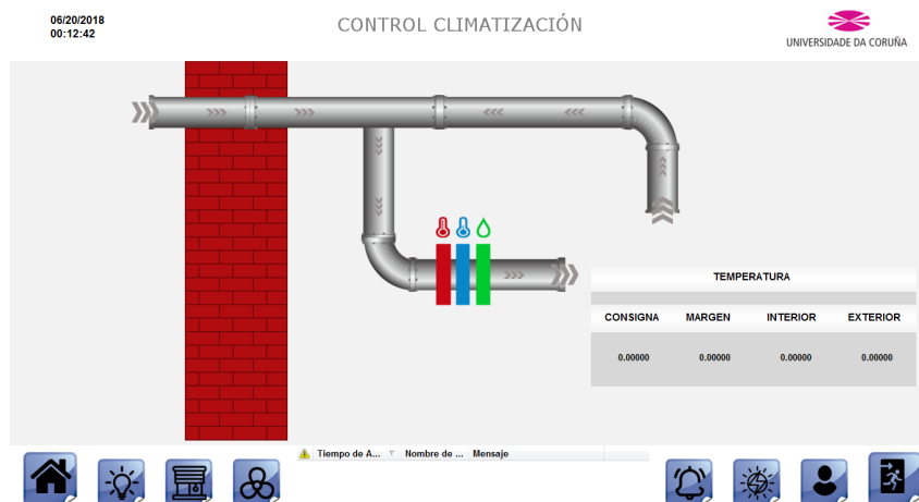
Figura 8.2.3.5 – Pantalla climatización SCADA.
