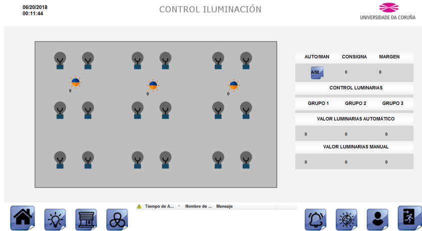
Figura 8.2.3.2 – Pantalla iluminación SCADA.
