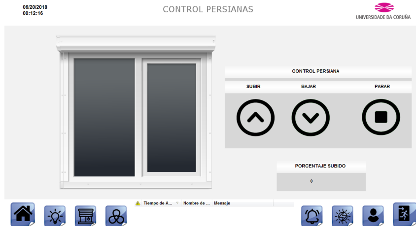
Figura 8.2.3.4 – Pantalla sombreado SCADA.
