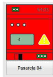
Figura 8.1.3.22 – Pasarela en estado de fallo
