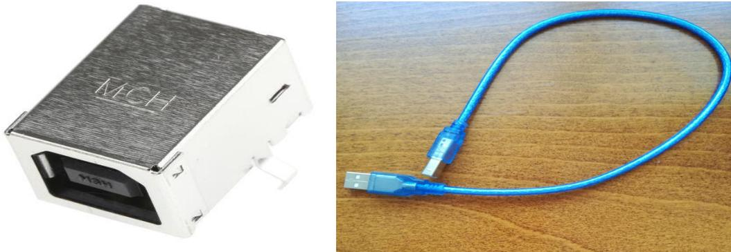
**Imagen 2.7.1.2 – Conector tipo B y cable A-B**
