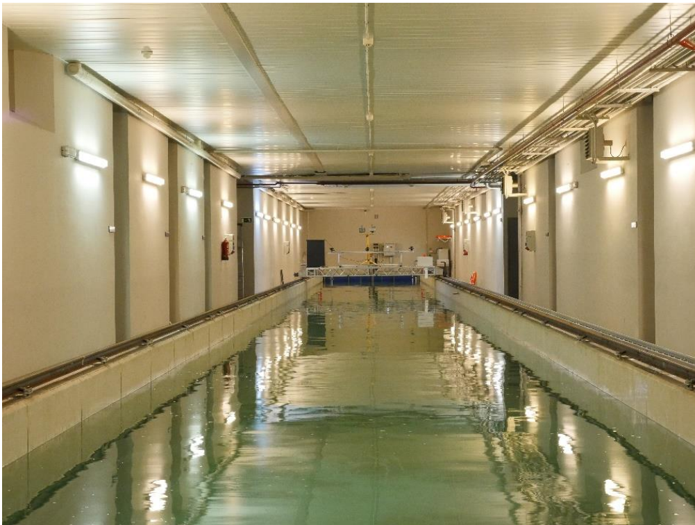
Figura 6.1. Canle de Experiencias hidrodinámicas.
