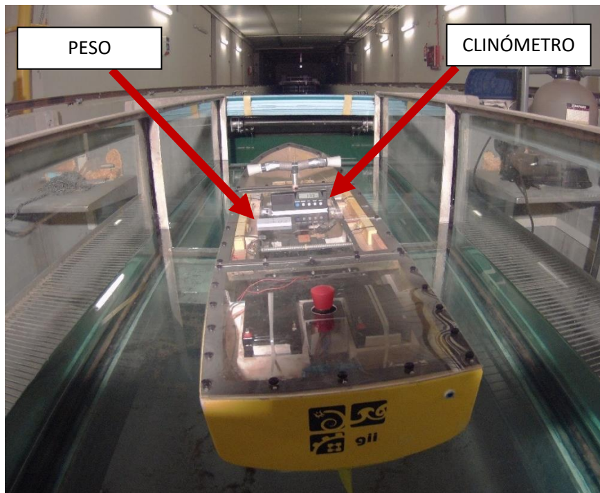
Figura 7.5. Modelo durante a proba de estabilidade.
