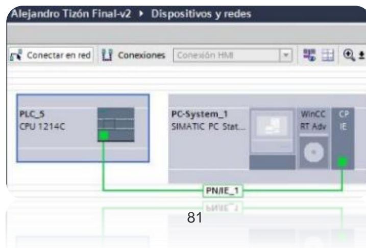
Imagen 21: Configuración de la conexión entre CPU, PLC y módulos de expansión
