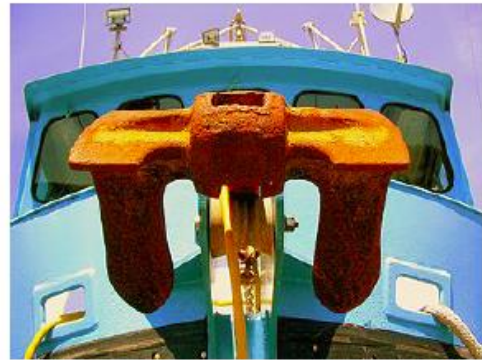
Corrosión de un ancla
