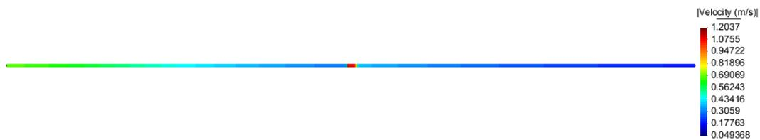
**Figura 106:** Módulo de la velocidad del flujo en el Estrechamiento de poca longitud en régimen lento con nivel impuesto.
