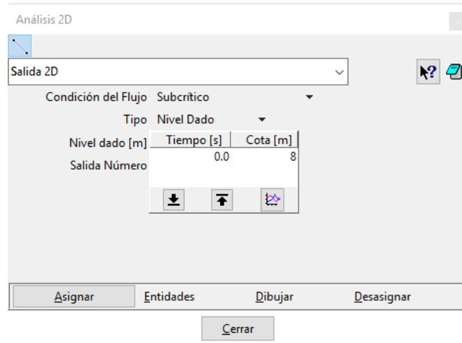
Figura 35: Condición de contorno de salida para generar una curva S1.
