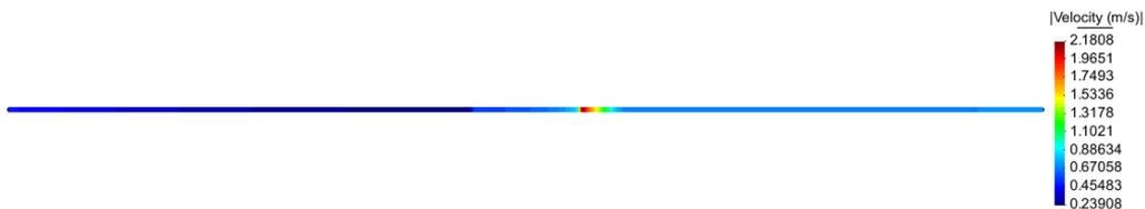
Figura 117: Módulo de la velocidad del flujo en el Escalón de poca longitud en régimen lento con nivel impuesto.
