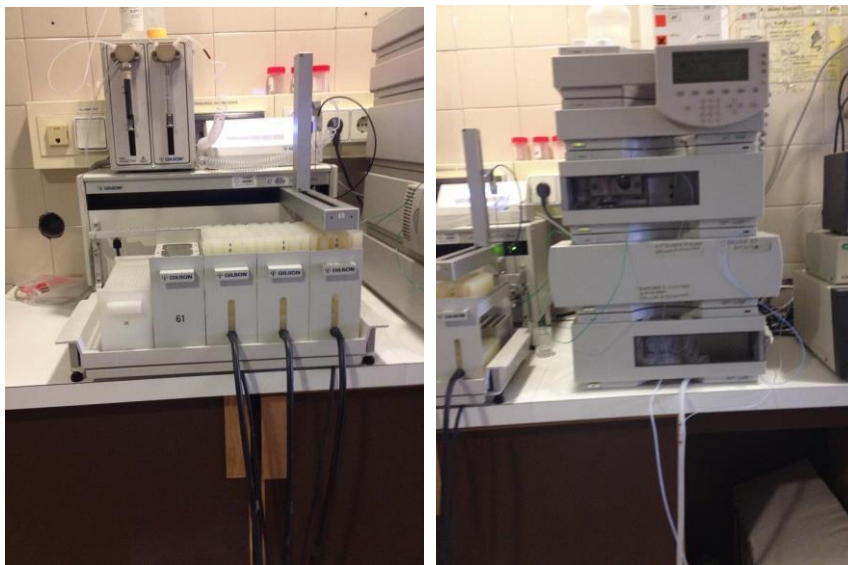
Ilustración 47: HPLC para la determinación de catecolaminas y metanefrinas
