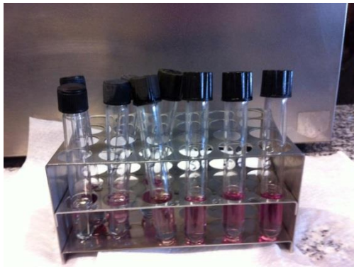
Ilustración 24: Curva de calibración después de introducirlo en un baño de agua a 100°C.
