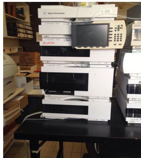
Ilustración 27: HPLC para las porfirinas
