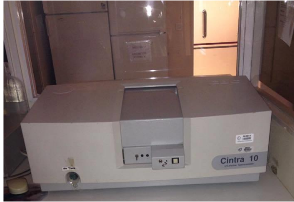
Ilustración 21: Espectrofotómetro UV-VIS de marca CINTRA 10 para la determinación de FA.
