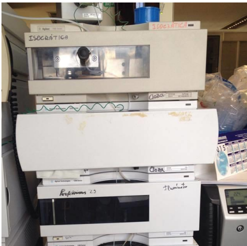
Ilustración 27: HPLC para las porfirinas
