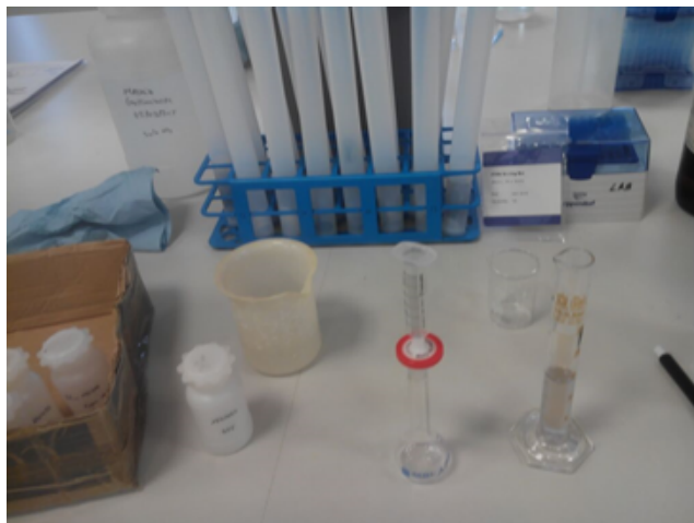
Figura 4. Filtración de la alícuota por un filtro de 0,45 µm
