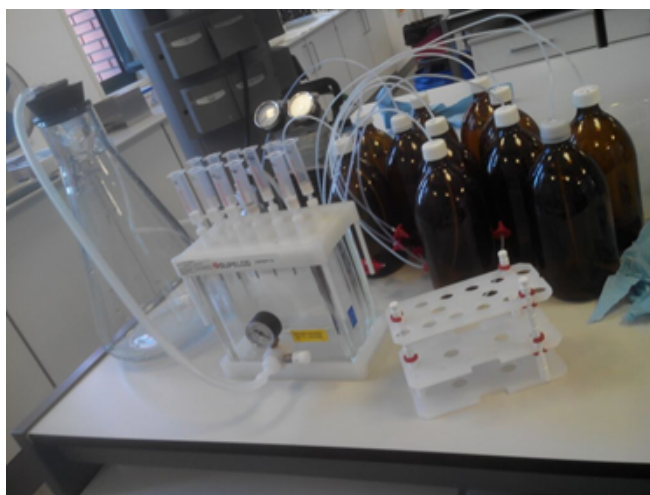
Figura 7. Extracción a vacío en columna C 18 de 500mg-6mL ISOLUTE SPE
