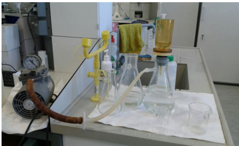
Figura 5. Sistema de filtración a vacío.
