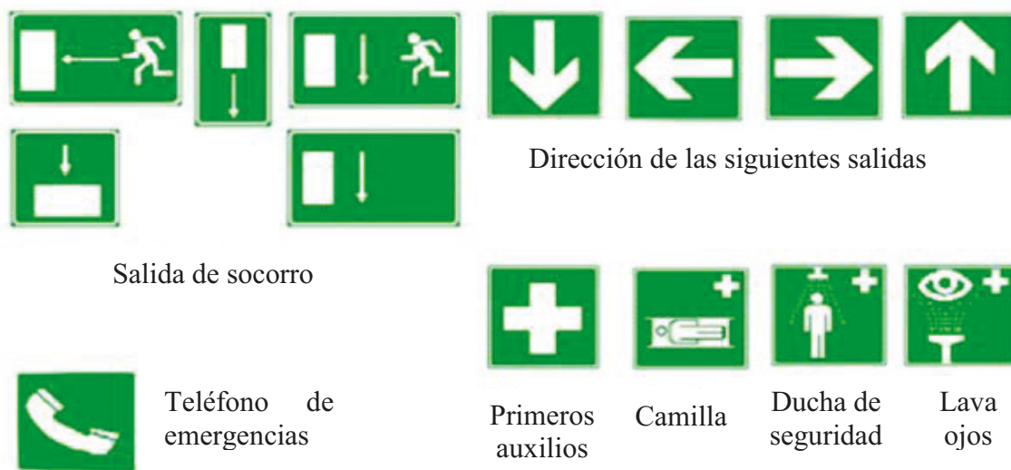
Ilustración 24. Señalización salvamento y vías de seguridad.
