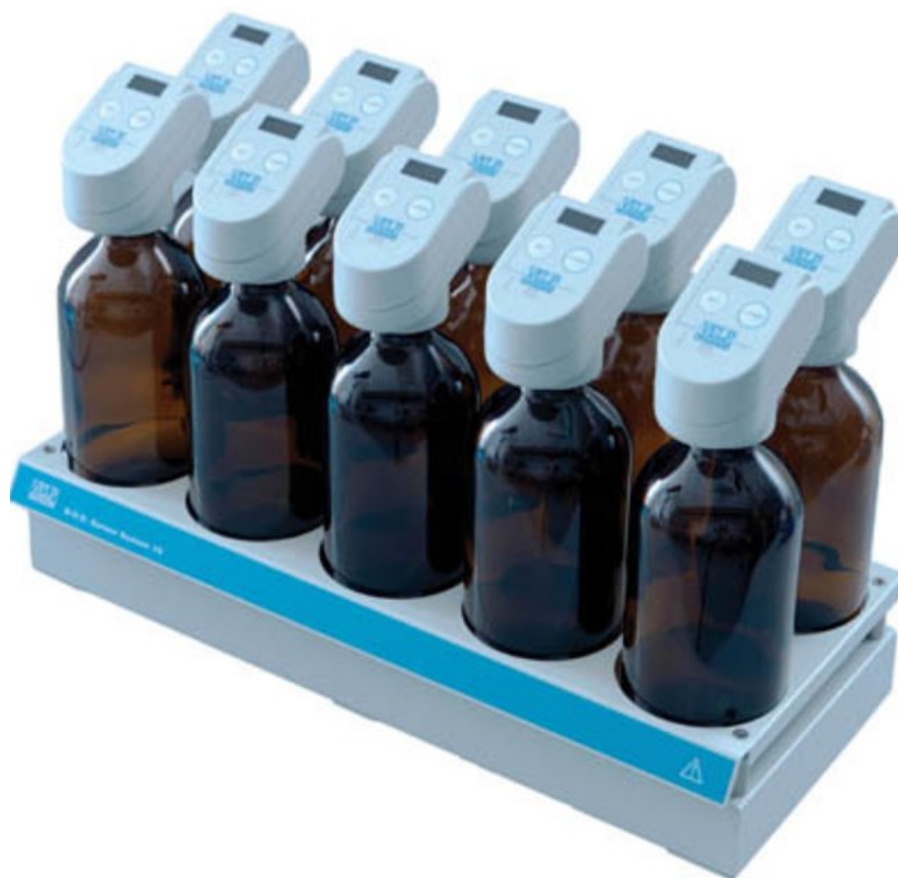
Figura 5: Base axitadora, botellas de vidro e medidores da DBO da marca Velp.
