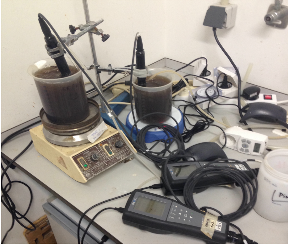
Figura 1: Equipamento e montaxe utilizado na determinación da respirometría de mostras de compost.
