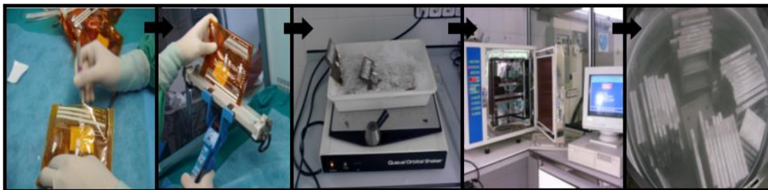
Se colocan los parches en bolsas con medio de criopreservación Se sellan las bolsas Se dejan en hielo para equilibrar Se realiza la congelación controlada Se guardan las bolsas en fase gas del N 2 L
