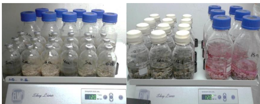
Figura 13. Disposición dos tres tipos de ensaios (metanoxénicos, de denitrificación e nitrificación) nos axitadores orbitais.
