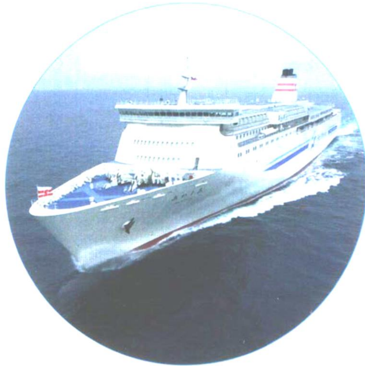
Imagen 51. RoPax “Akashia” construido en los astilleros Japoneses de Mitsubishi en Nagasaki, tienen una eslora de 224,5 metros y desarrollan una velocidad de crucero de 31,5 nudos. Ha sido el primer barco en el mundo en estar equipado con ABB's contra-rotating CRP Azipod propulsión system
