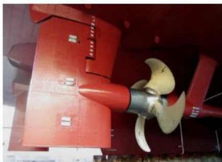
Imagen 41. Hélice de paso variable con timón acoplado a popa.
