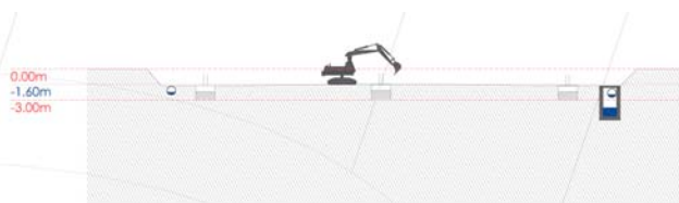
CUARTA FASE: Construcción de los pozos de cimentación hasta cota -3.00m (cota de terreno resistente) y de las zapatas, creando así un perímetro cerrado.
