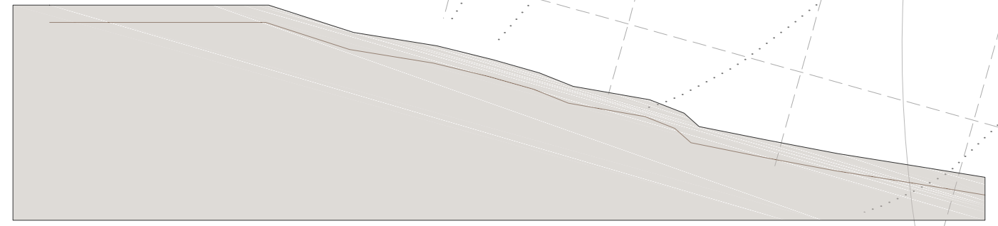
Terreno natural de terreno, con cota resistente a 1.3m de altura.
