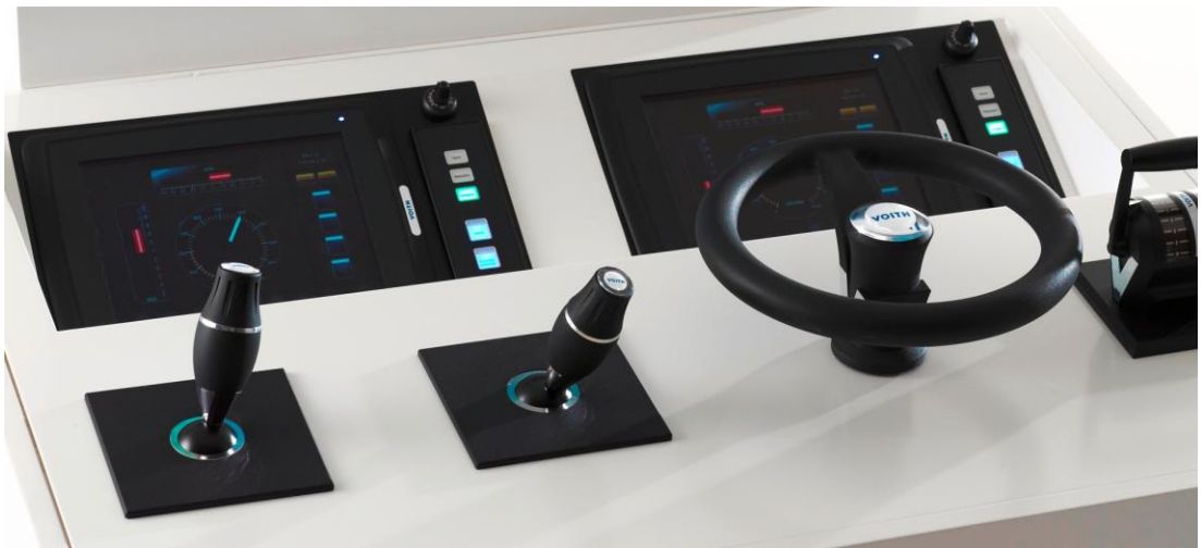
Figura 2.8.2.1: Consola de control electrónico de VSP Fuente: Conferencia "VTSH Control". 28 mayo 2013
