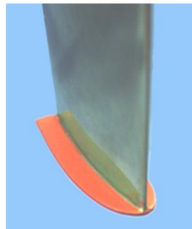
Figura 2.4.6: Palas de VSP para evitar vorticidad.
