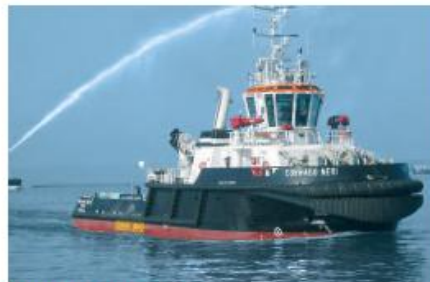
110 T BP ASD TUG CORRADO NERI 2 x SCHOTTEL Rudderpropeller Type SRP 3030 CP (3080 kW each)
