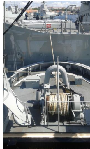
Figura 6.4.2.2: Remolcador Y-126 empujando en la amura y detalle del punto de afirmado
