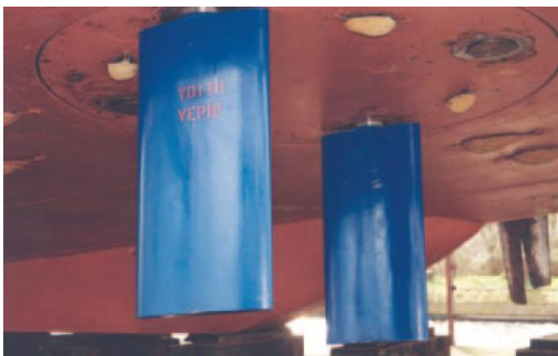
Figura 4.3.2: Imagen de un VSP de 4 palas convertido en VCR.
