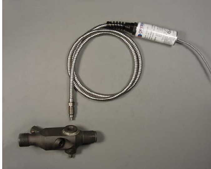
Foto 2. Detalle del sensor de presión con su módulo electrónico.
