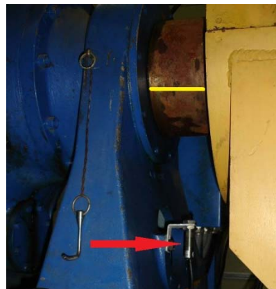
Foto 7. Sensor óptico, y marca reflectante.
