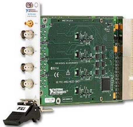
Foto 12. Módulo ADC NI PXI-4462.
