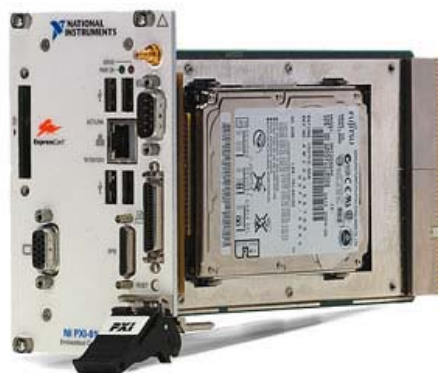
Foto 10. Módulo procesador NI PXI-8119.
