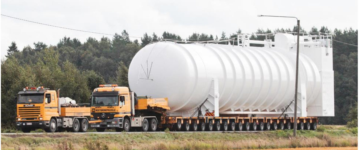
Figura 2.9.1.1.1.2.1 – Tanque del LNG pack [33]
