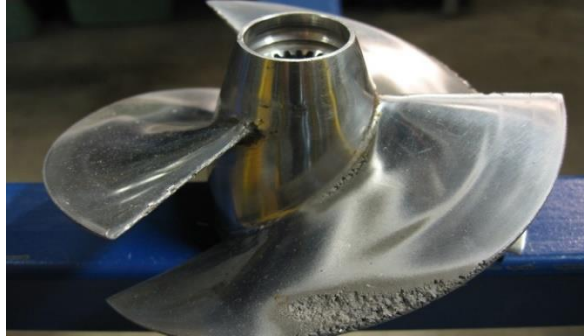
Ilustración 20-Corrosión por cavitación, hélice
