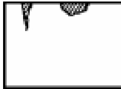
Ilustración 7-Corrosión por picadura
