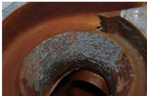
Ilustración 19-Corrosión por cavitación, bomba de refrigeración coche
