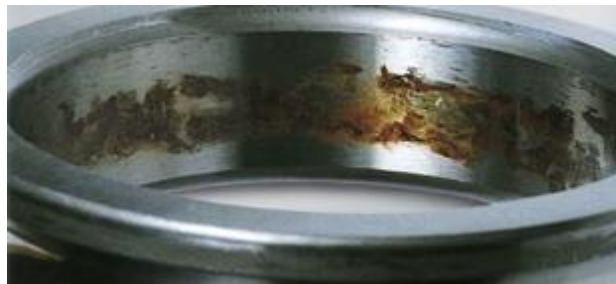
Ilustración 17-Corrosión por fricción, rodamiento
