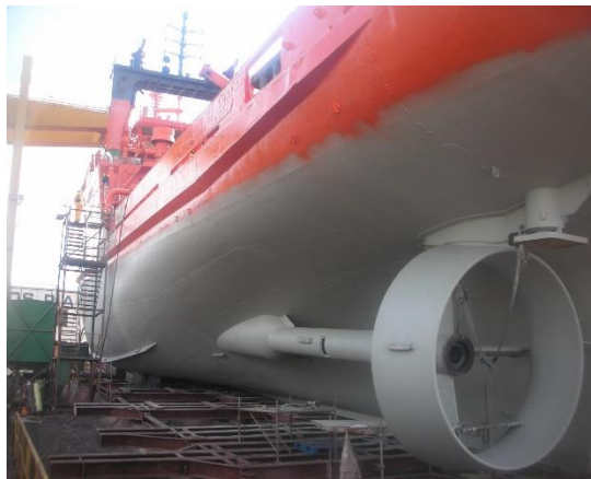
Ilustración 27-Aplicación de protección pasiva 1
