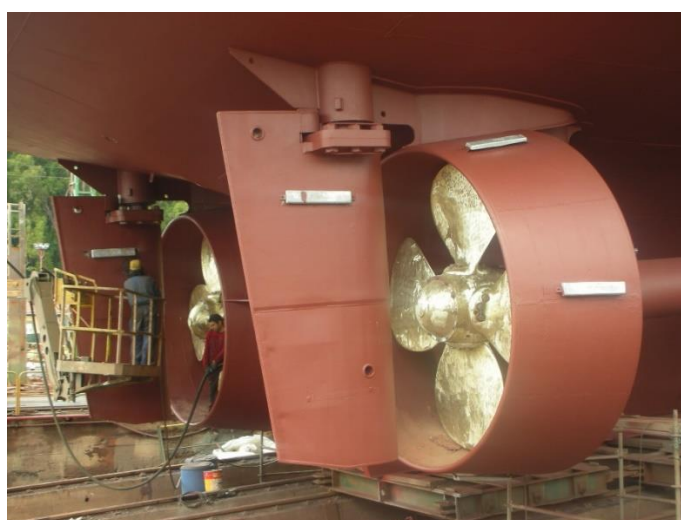
Ilustración 38-Ánodos en toberas y palas de los timones
