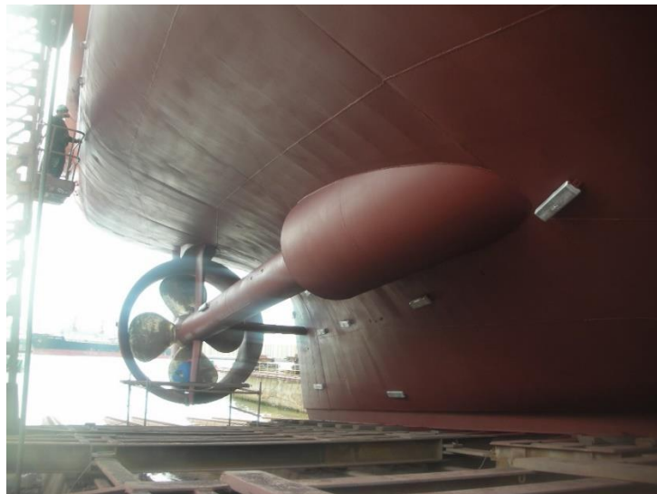
Ilustración 36-Ánodos en la obra viva del casco
