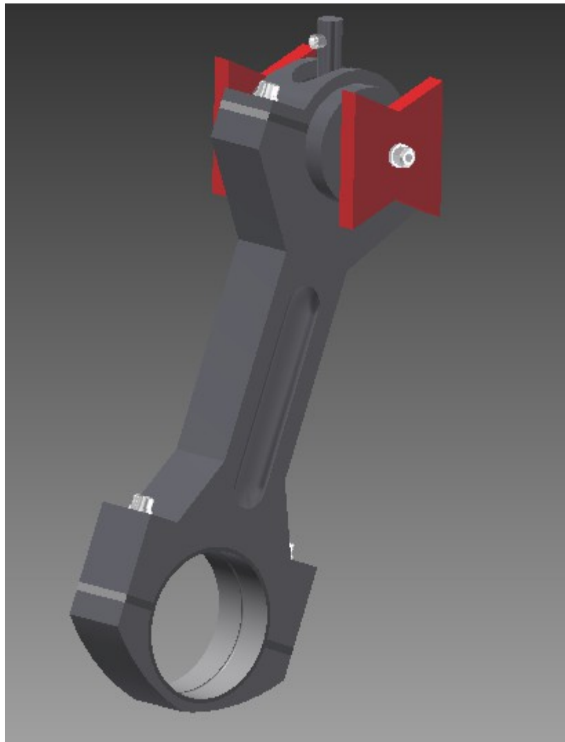
Figura 3.6.1 - Biela - cruceta, ensamble
