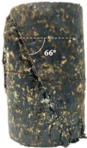
**Figura 8. Ejemplo de probeta rota tras ensayo triaxial de deformación permanente**
