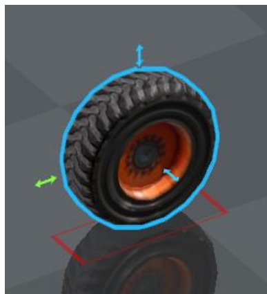
Fig 2.20 Sólido 4.2 de la carretilla. Rueda delantera izquierda
