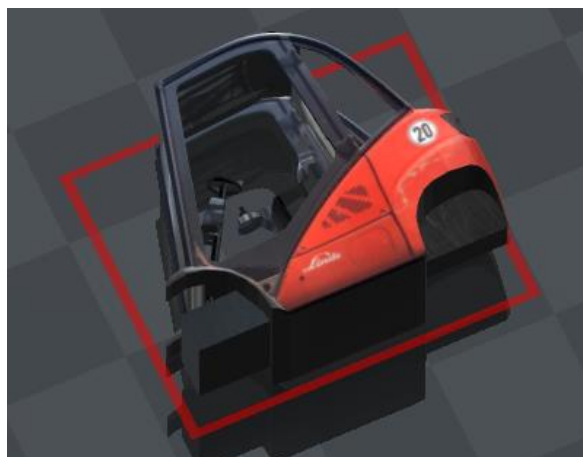
Fig 2.5 Sólido 1 de la carretilla. Chasis y cabina
