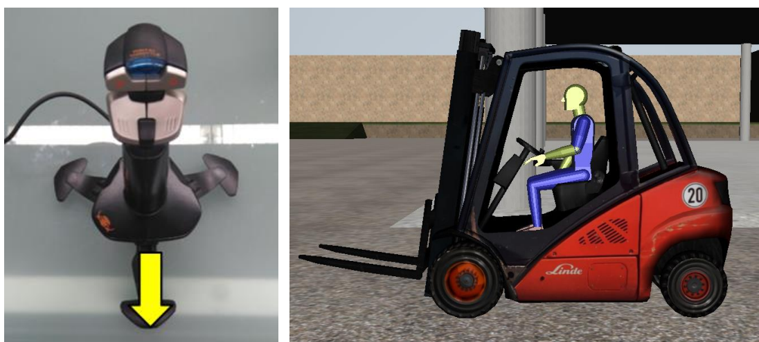
Fig 6.3 Joystick, inclinación del mástil hacia atrás
