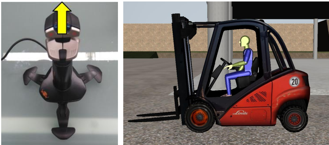
Fig 6.2 Joystick, inclinación del mástil hacia delante
