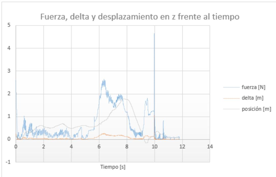
Figura 56. Fuerza, delta y desplazamiento en z frente al tiempo para el caso de una colisión a velocidad constante
