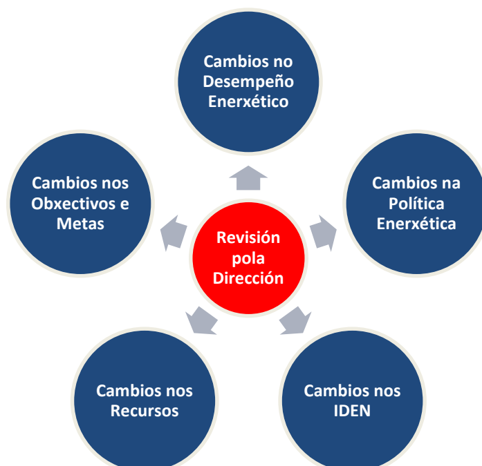
Ilustración 9 Resultados da revisión pola Dirección. Fonte: “Guía Gestión Aplicación de un Sistema de Gestión Energética en el Sector Industrial”
