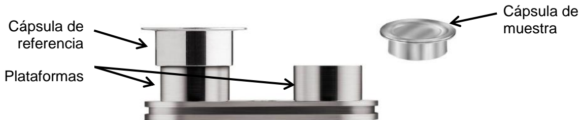
Figura 5: Estructura esquemática de la celda de medición DSC
