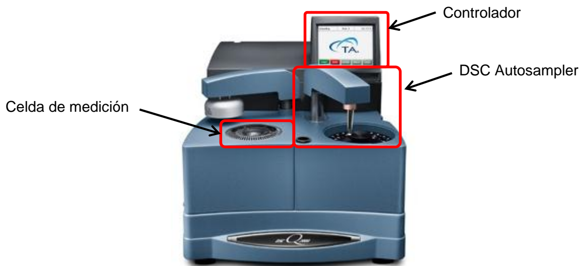
Figura 4: DSC Q2000 TA Instruments. Componentes y accesorios principales
