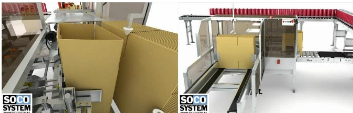
Figura 1: Ejemplo de una máquina de apertura de cajas (SOCO System [sin fecha])
