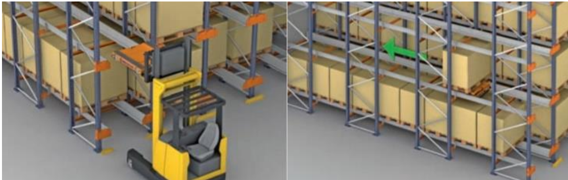
Figura 5: Ejemplo de manejo de sistema que emplea carretillas elevadoras en conjunto con un shuttle (MECALUX ESMENA 2016)
