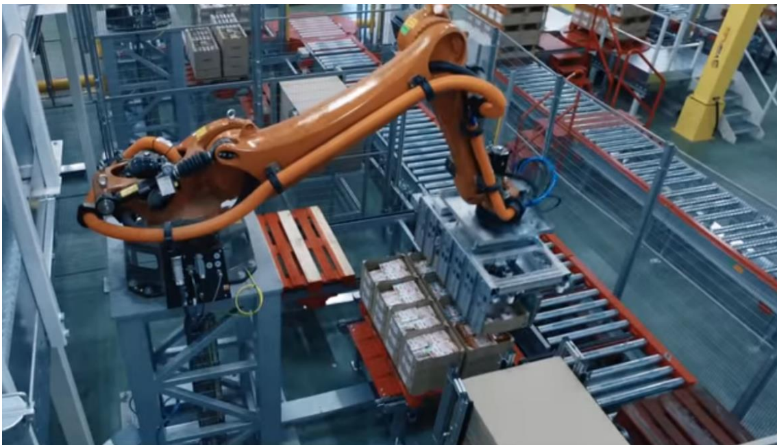
Figura 2: Paletizadora KUKA en INTERMARCHÉ (ULMA Handling Systems 2016)
