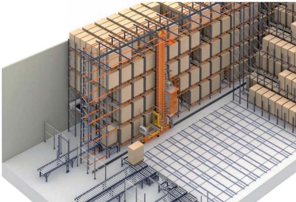
Figura 6: Ejemplo de Automated Storage & Retrieval – ASRS (MECALUX ESMENA 2016)
