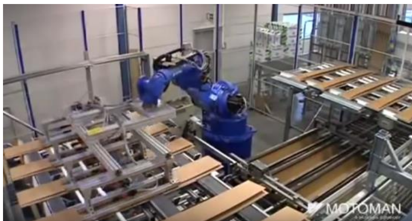
Figura 51: Ejemplo de manipulador que permite colocar cuatro piezas simultáneamente. (Yaskawa UK 2011)
