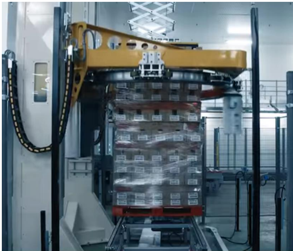
Figura 4: Enfardadora automática de palés (ULMA Handling Systems 2016)
