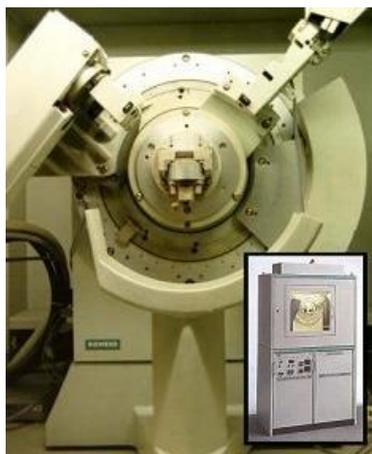
Figura 6: Difractómetro Siemens D5000
