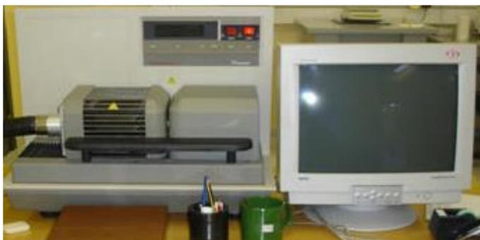
Figura 7: Equipo de análisis termogravimétrico TA Instruments STD 2960
