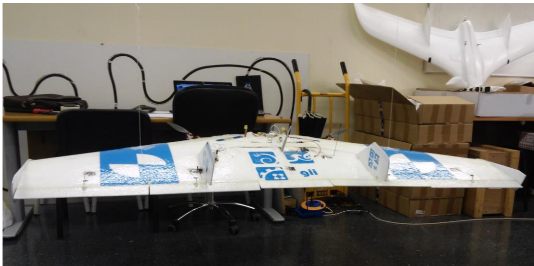
Posición para la inercia del eje z del UAV (2)
