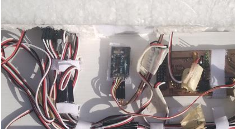
Ilustración 4.31: Localización del IMU en el UAV
