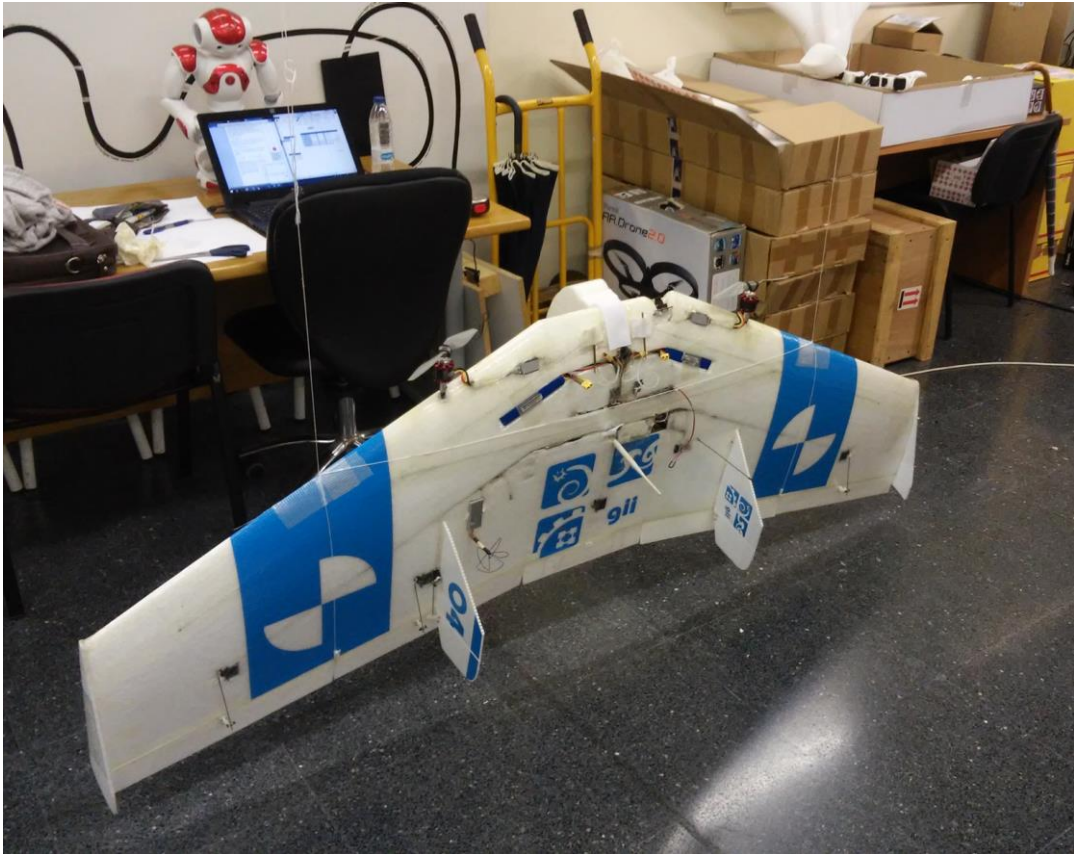
Posición para la inercia del eje x del UAV (1)
