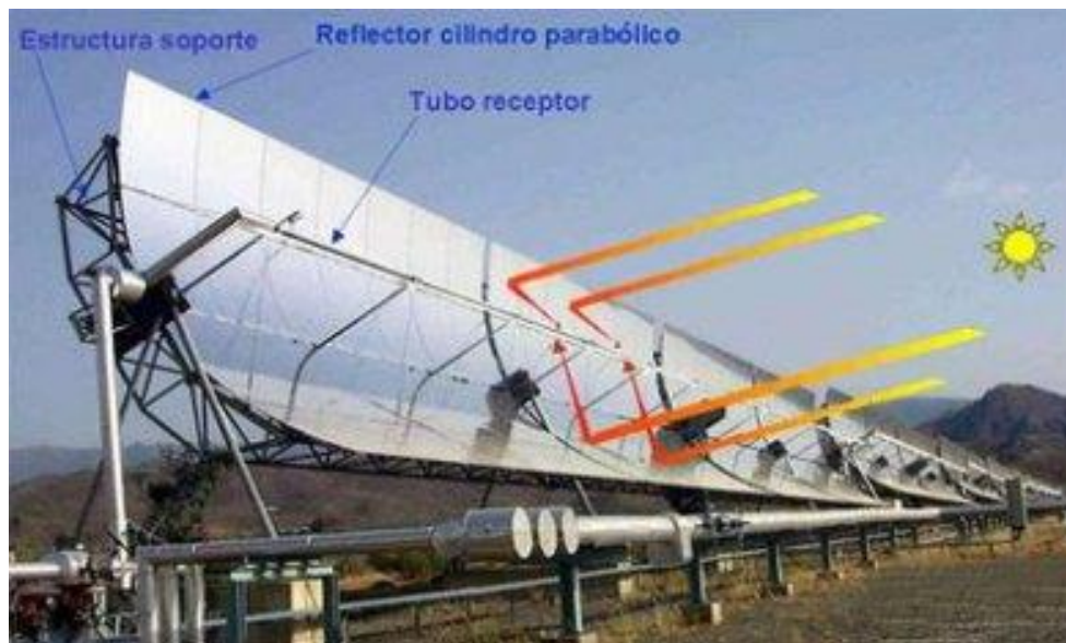
Figura 23. Captador solar de cilindro parabólico [ https://themorningstarg2.wordpress.com/tag/colectores-cilindro-parabolicos/ ].
