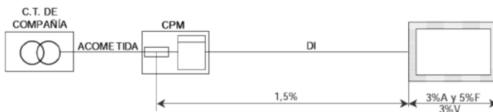
Figura 3.3.6.2 Caídas Máximas de Tensión
