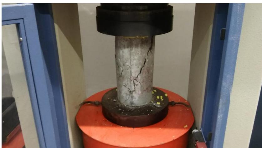
*Figura 6.3.2.5.1 Colocación de las probetas dentro de la máquina.*
