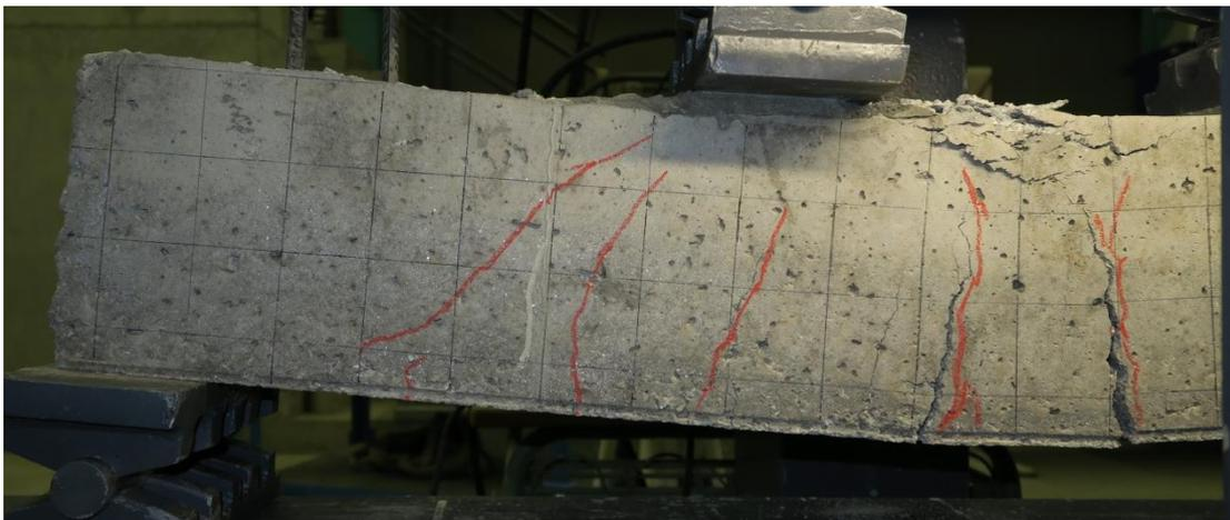
*Figura 7.2.1.5 Viga después del desprendimiento de la cabeza de compresión en la parte central.*
