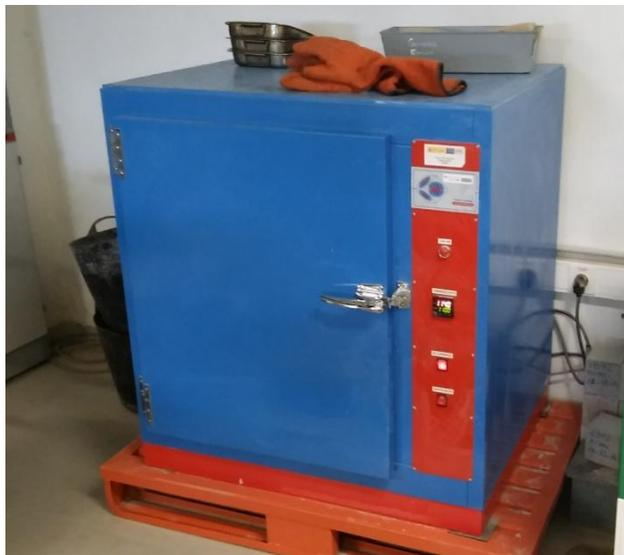
*Figura 4.1.4.2. Estufa ventilada para la eliminación de humedad.*
