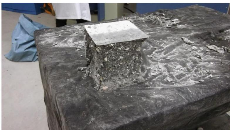
*Figura 6.3.4.5.2 Probeta después de realizar el ensayo a compresión.*
