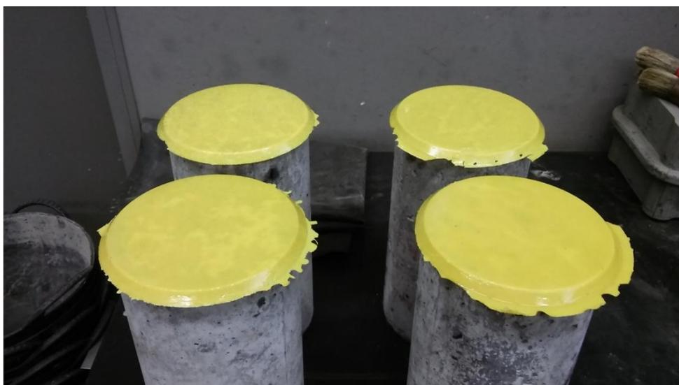
*Figura 6.2.4.6.3. Refrentado en probetas.*
