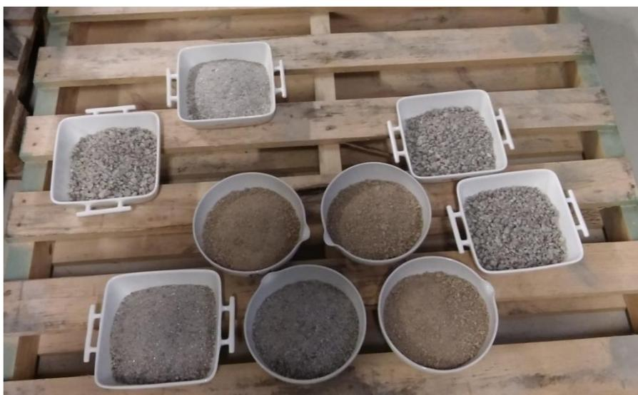
Figura 4.1.4.1. Muestras utilizadas durante el ensayo granulométrico.
