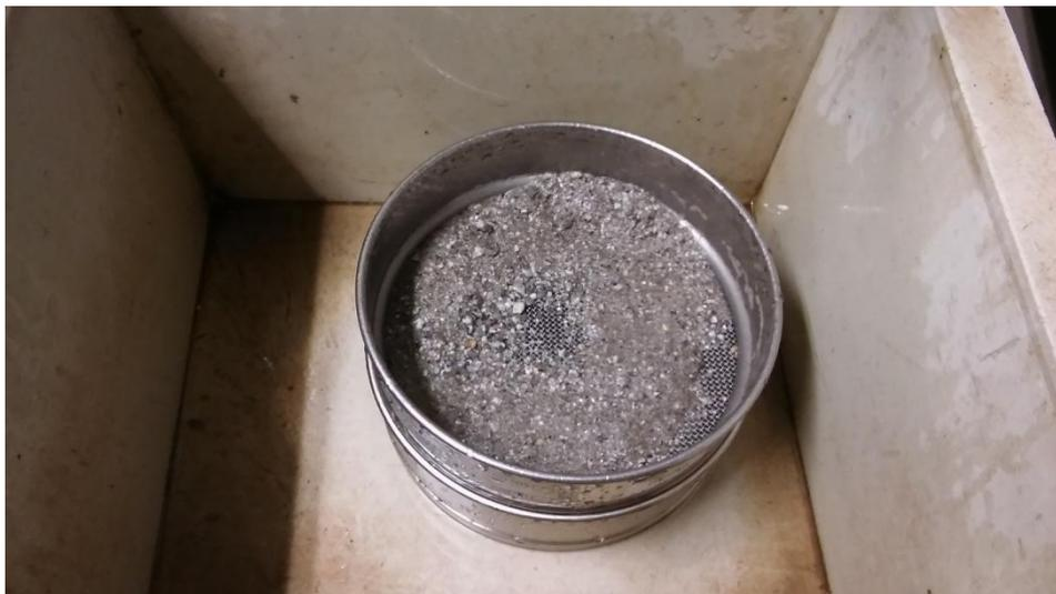
*Figura 4.1.4.3. Lavado de áridos para la eliminación de áridos finos.*
