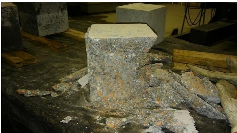
*Figura 6.3.3.5.4 Probeta después de realizar el ensayo a compresión.*
