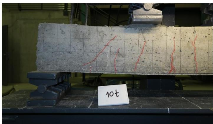
*Figura 6.4.2.4.4. Viga durante el ensayo con las fisuras marcadas y con una flecha significativa.*
