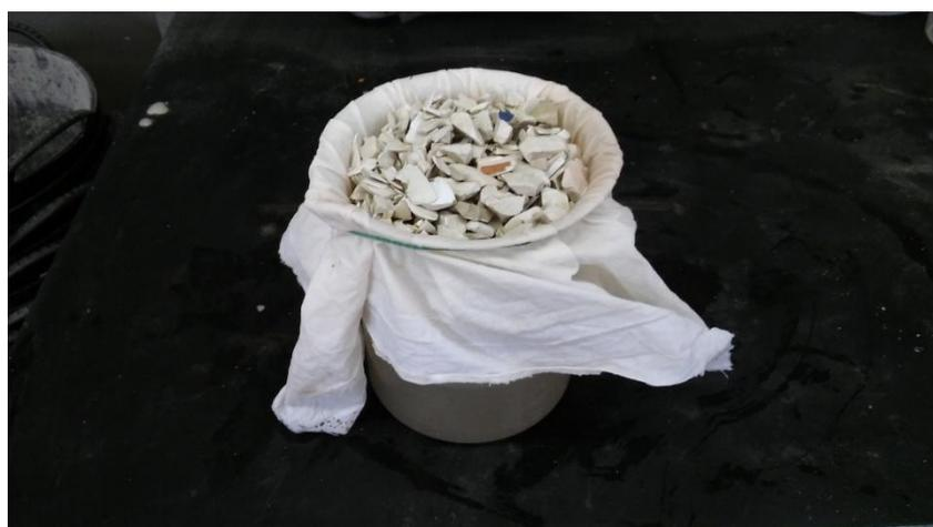
*Figura 4.4.3.2. Vaso medidor con tela de tamiz.*
