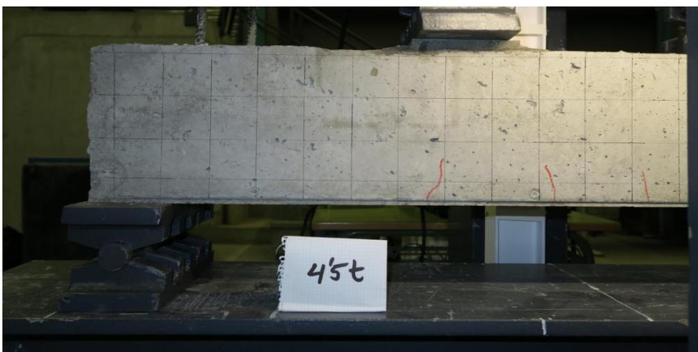
*Figura 7.2.1.3 Primeras fisuras en la viga.*
