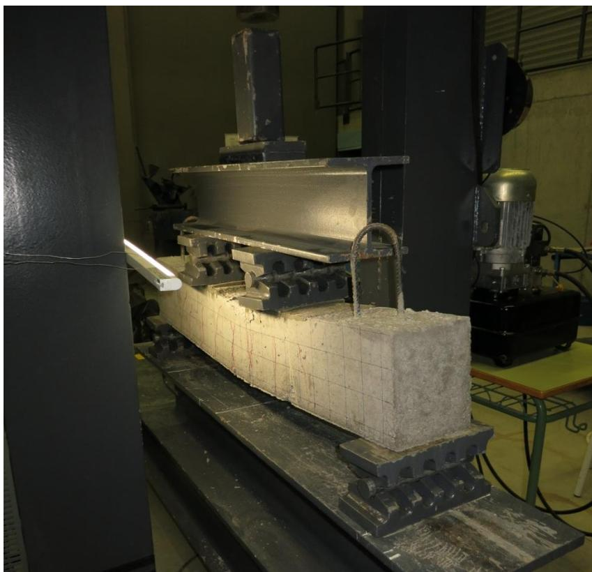
*Figura 6.4.2.4.1. Viga preparada en el pórtico.*
