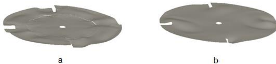
Figura 34: Deformación estimada (a) y obtenida con VOF (b) en el caso con baffles
