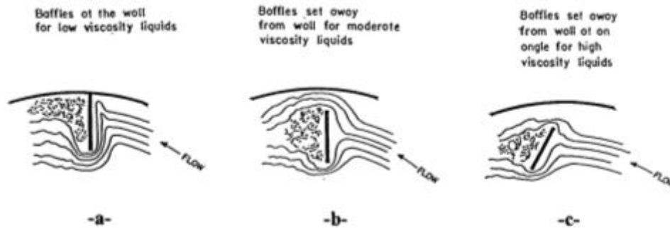
Figura 2: Disposiciones distintas de los baffles según la viscosidad del fluido.
