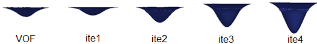
Figura 33: Comparativa de la deformación estimada de la superficie libre por el método iterativo y la obtenida mediante VOF en el caso sin baffles
