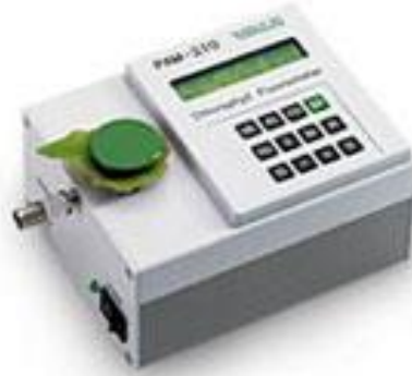
Figura 3: fluorímetro PAM-210 (Walz), utilizado en los ensayos de fluorescencia.
