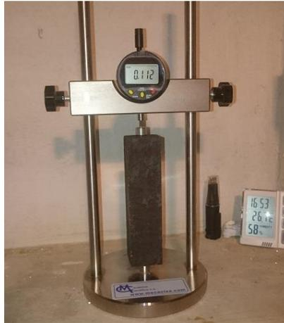
Figura 60: Medición de probeta para ensayo de retracción
