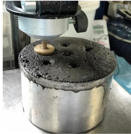
Figura 53: Proceso del ensayo de tiempo abierto de trabajabilidad
