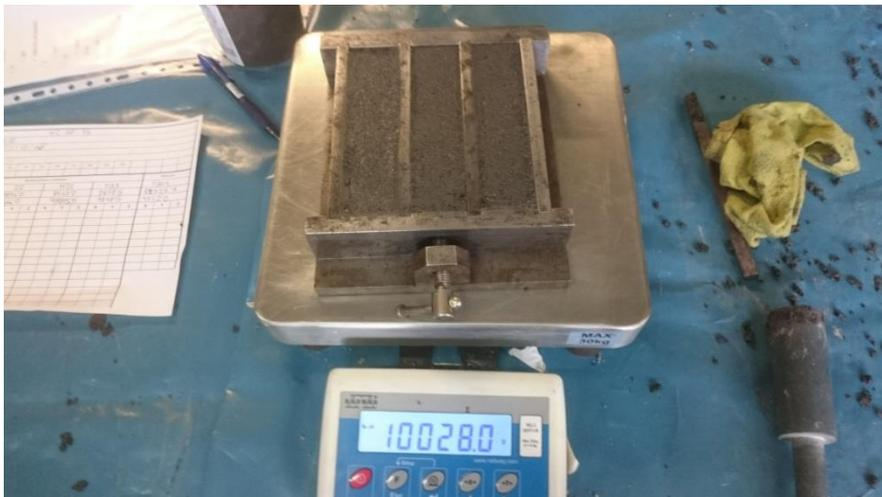
Figura 45: Molde de mortero lleno, pesándose en báscula para calcular la densidad fresca
