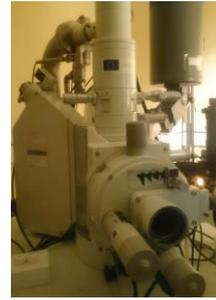
Figura 102: Microscopio de barrido electrónico
