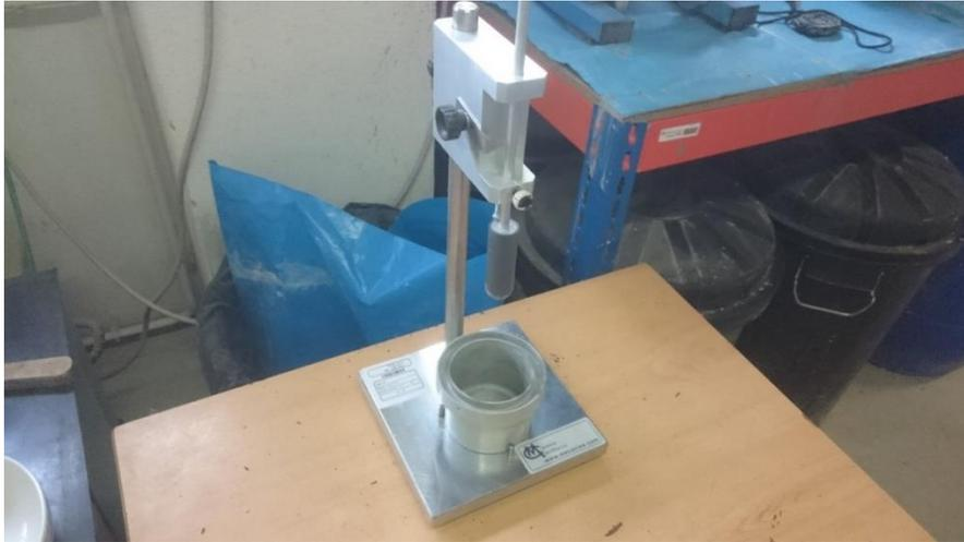
Figura 48: Aparato para ensayo de penetración de pistón
