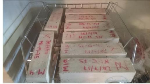
Figura 114: Curado de probetas de mortero en la cámara climática
