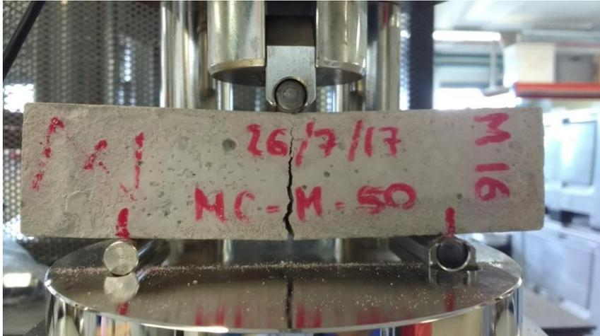
Figura 58: Dispositivo de ensayo a flexión y probeta ensayada
