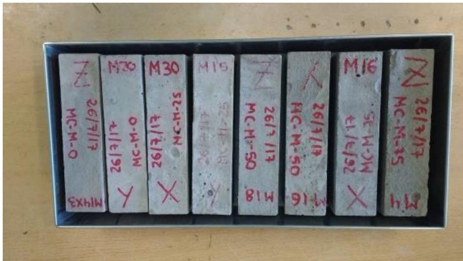
Figura 116: Probetas de mortero con ceniza de la central 2 ordenadas de menor a mayor contenido de ceniza
