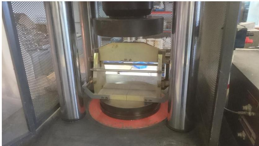
Figura 65: Dispositivo para realizar ensayo a tracción de probetas cilíndricas
