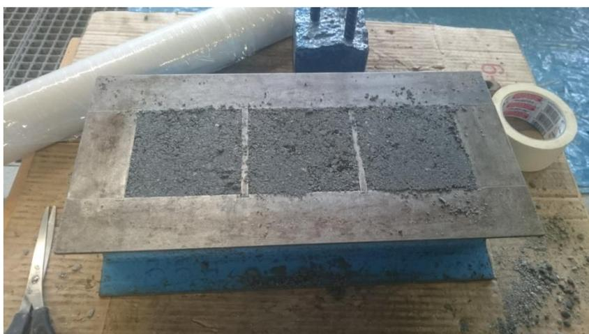
Figura 62: Molde de probetas cúbicas listo para ser pesado
