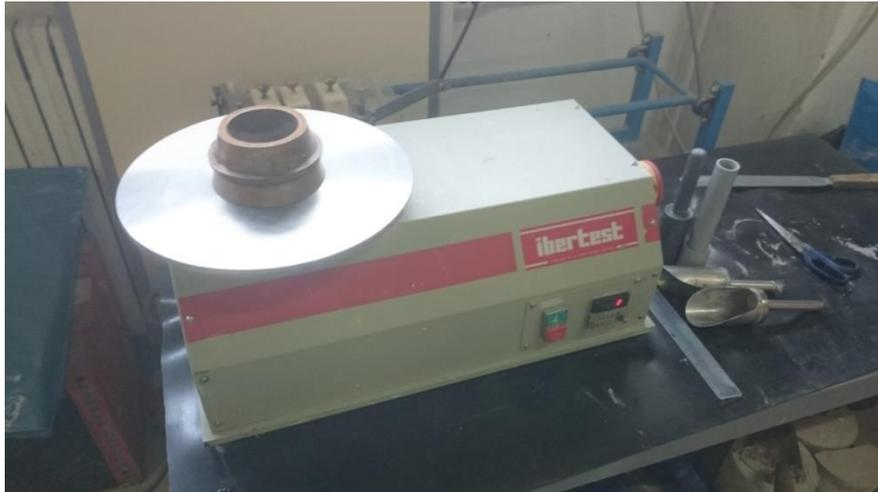
Figura 46: Máquina para ensayo minislump
