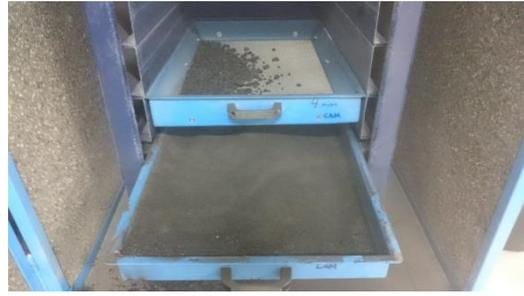
Figura 97: Tamizadora de gran tamaño para cortar en fracciones la ceniza
