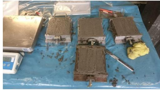
Figura 118: Tarado y llenado de moldes de mortero
