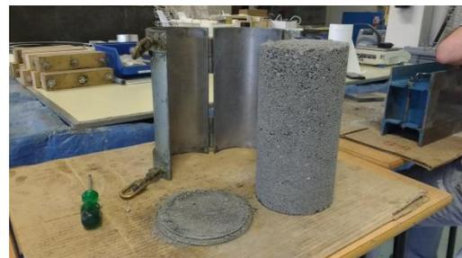
Figura 112: Desmoldado de probetas
