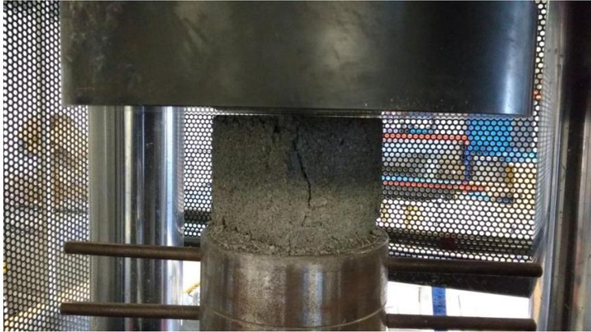
Figura 64: Probeta cúbica de hormigón ensayada a compresión
