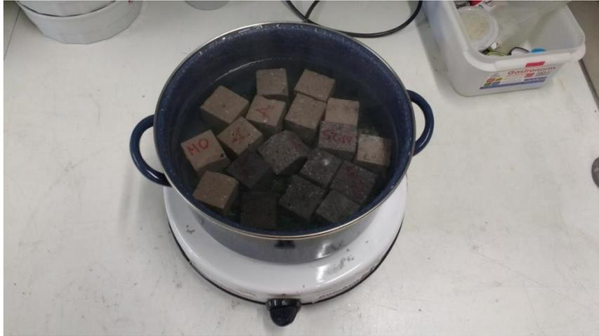
Figura 56: Probetas en agua hirviendo durante el ensayo de absorción
