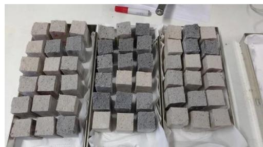
Figura 121: Probetas de mortero para ensayo de capilaridad
