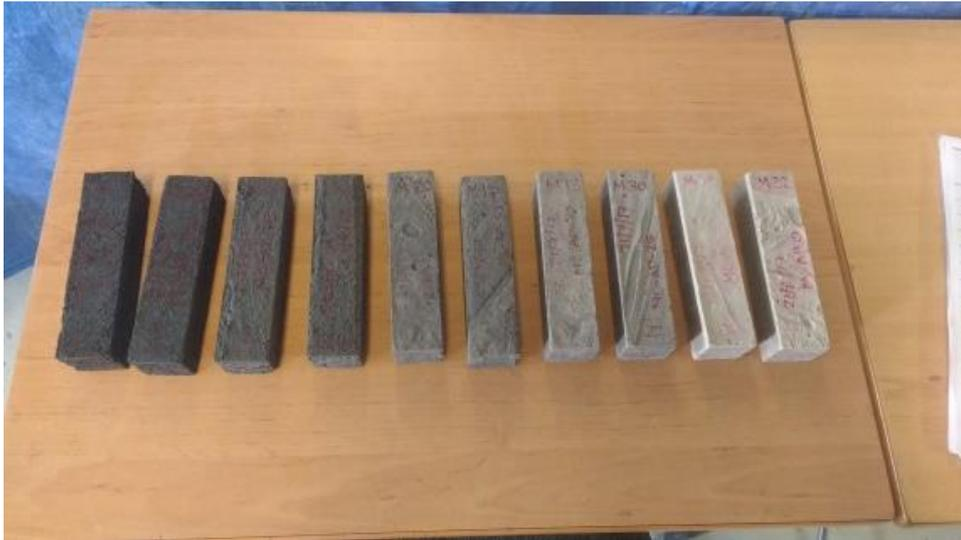
Figura 115: Probetas de mortero con ceniza de la central 1 ordenadas de mayor a menor cantidad de cenizas
