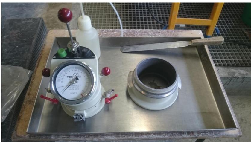
Figura 51: Aparato para realizar el ensayo de contenido de aire en morteros
