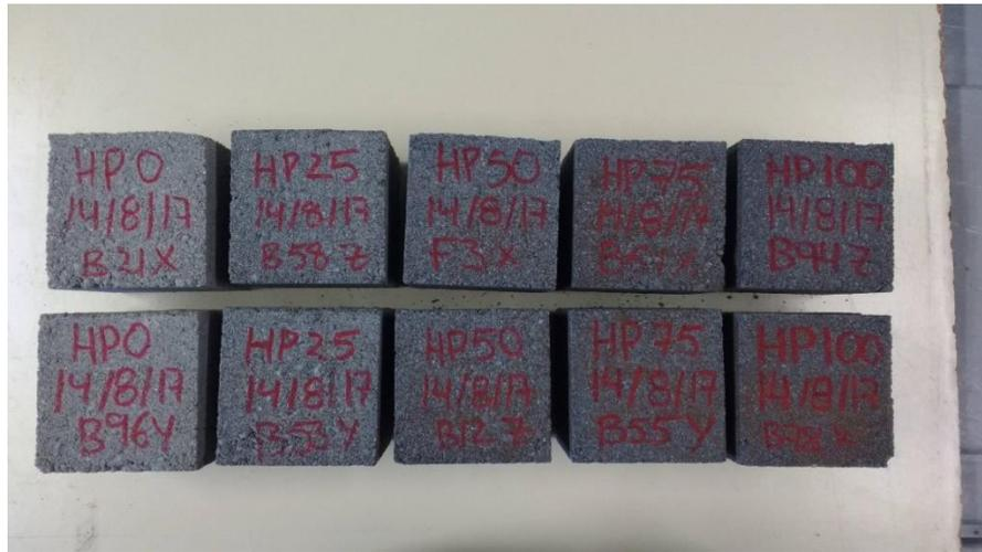
Figura 117: Probetas de hormigón para prefabricados ordenadas de menor a mayor contenido de ceniza
