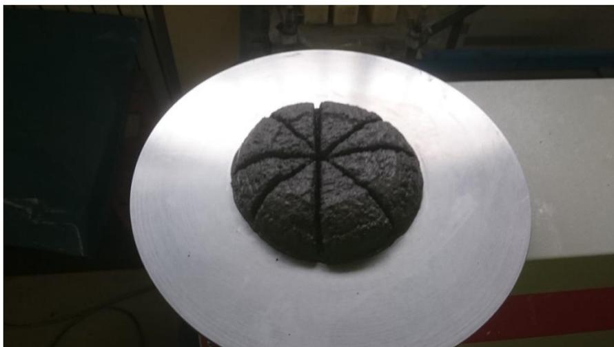
Figura 47: Torta tras ensayo minislump y ser medida
