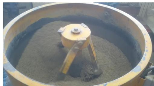
Figura 111: Amasado de los hormigones para prefabricados
