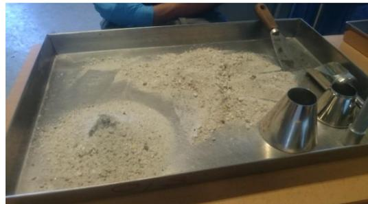
Figura 98: Secado de árido para ensayo norma UNE-EN 1097-6
