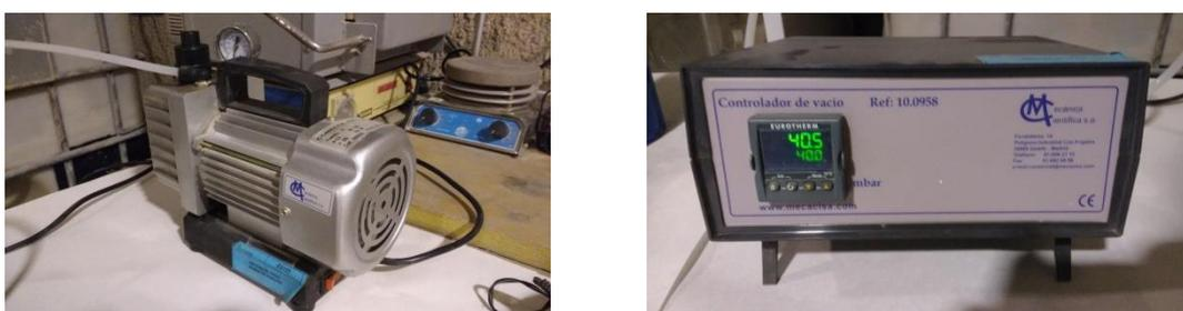
Figura 91: Motor y controlador de equipo de vacío
