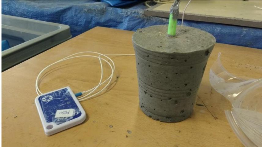
Figura 55: Probeta de mortero, con sensor de temperatura y tarjeta de toma de datos, tras finalizar el ensayo
