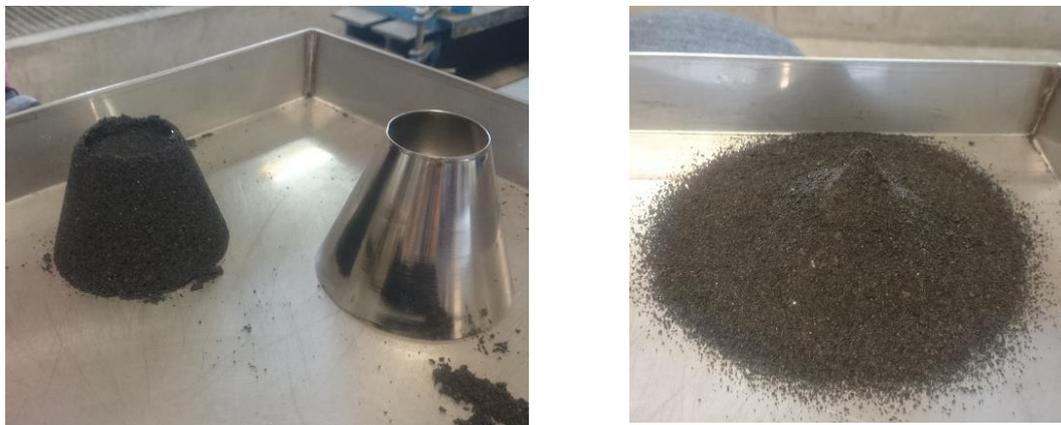
Figura 89: realización de cono con ceniza de la central 1
