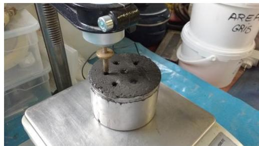
Figura 119: Ensayos de trabajabilidad en morteros
