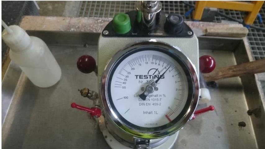
Figura 52: Resultado del ensayo de contenido en aire
