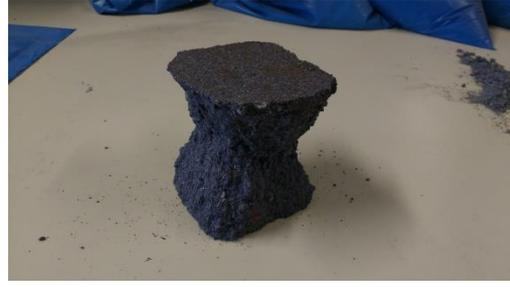
Figura 122: Ensayo a compresión de probetas cúbicas de hormigón para prefabricados
