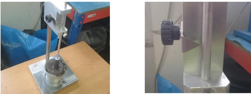
Figura 49: Ensayo de penetración de pistón y detalle del resultado
