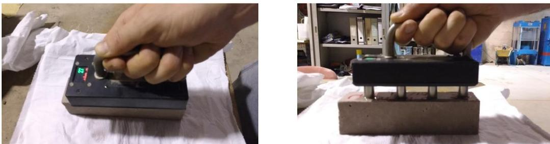
Figura 59: Aparato para ensayo de resistividad
