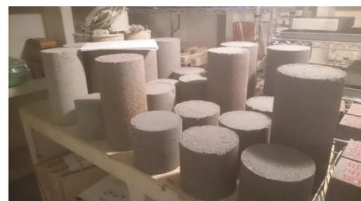
Figura 113: Curado de las probetas de hormigón para prefabricados en la cámara climática
