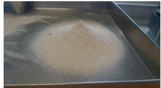
Figura 99: Realización de cono para ensayo de la norma UNE-EN 1097-6
