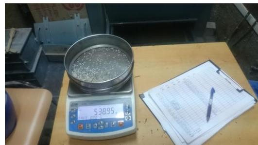
Figura 96: Tamizado de arenas para granulometrías
