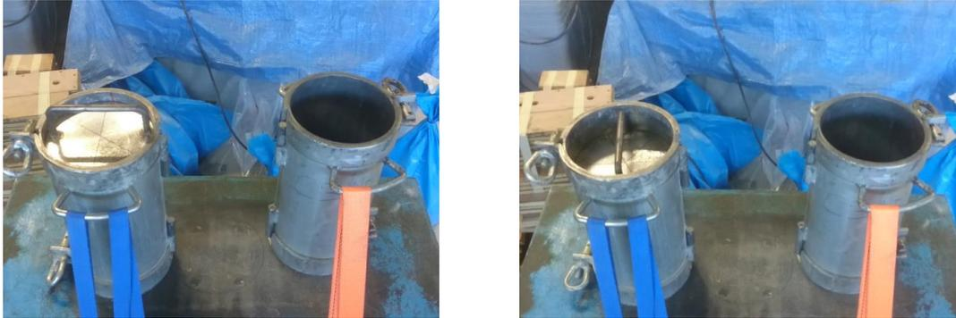
Figura 63: Moldes antes y después de vibrado
