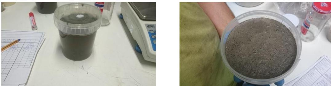
Figura 50: Recipiente lleno de mortero para ensayo de exudación
