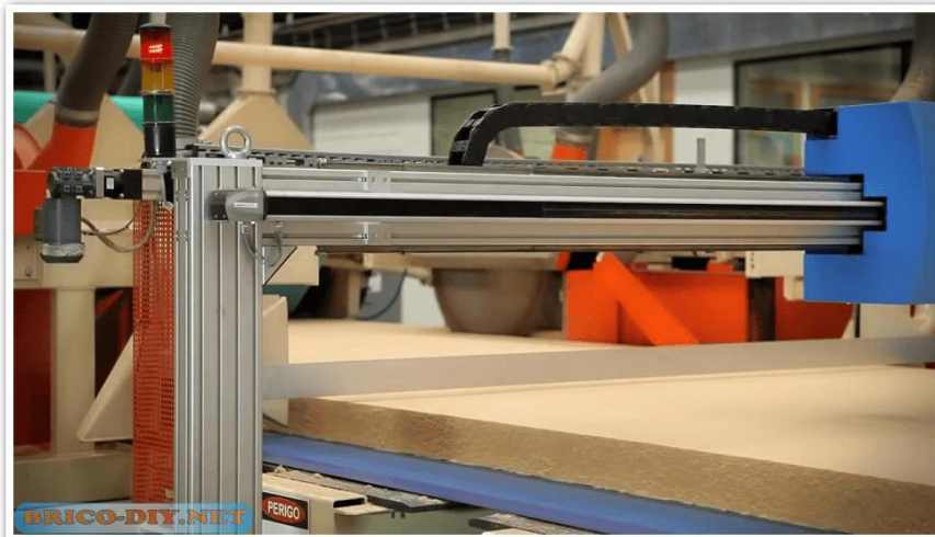
Figura 48. Formación de láminas de fibras encoladas. Fuente: www.brico-diy.net
