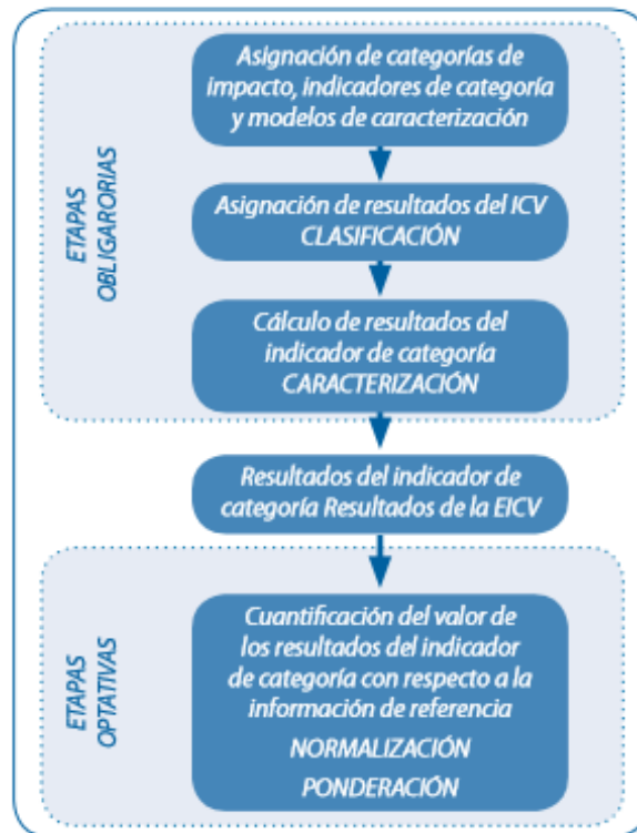
Figura 13. Esquema de la Fase de EICV según la norma ISO 14040. Fuente: Análisis de ciclo de vida y huella de carbono (IHOBE, 2009)
