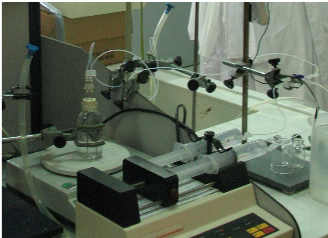
**Fotografía 8: Sujeciones del vial, de los tubos al tablero y de las llaves 3v.**
