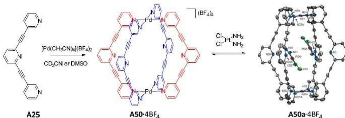
Figura 12: Esquema de autoensamblaje para la caja Pd 2 L 4 (A50), capaz de encapsular dos moléculas de Cisplatino. A la derecha se puede ver la estructura cristalina del complejo de inclusión (A50a). Los átomos de H han sido omitidos por claridad.
