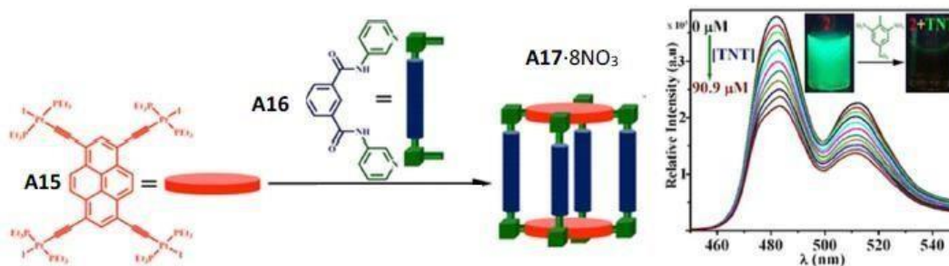
Figura 10: A la izquierda, esquema del ensamblaje del prisma tetragonal molecular, y a la derecha representación gráfica con la banda de emisión y su correspondiente disminución de la intensidad con la adición de alícuotas de TNT.
