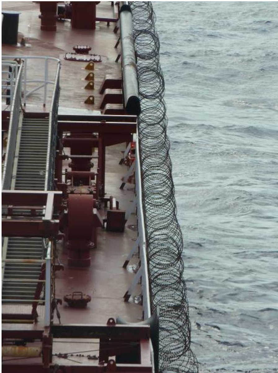
Figura 7.2 Alambre de espino extendido a la altura de la regala del costado de estribor del Algeciras Spirit en la Terminal Escravos (Delta del Níger-NG) a finales de 2015. Fuente: Manuel Ramirez (tercer Oficial de Puente)
