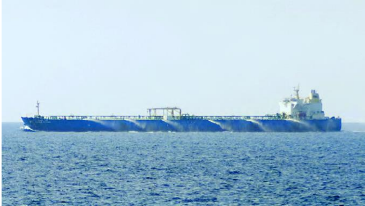
Figura 7.4 Medida anti-pirata empleando agua a presión en un buque tanque. Fuente: Fragata Victoria
