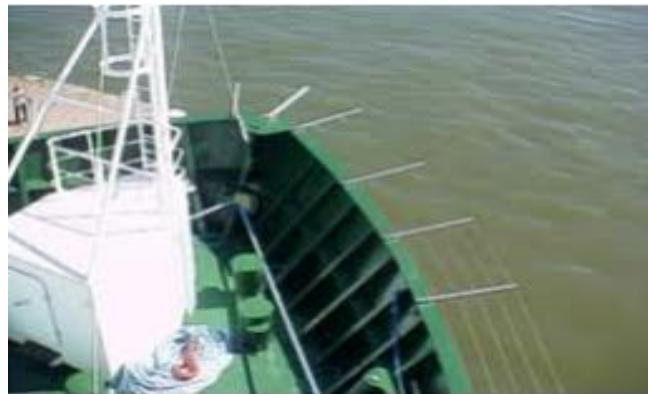
Figura 7.7 Cerca electrificada del sistema Secure-Ship. Fuente: Francisco José Vicente Álvarez
