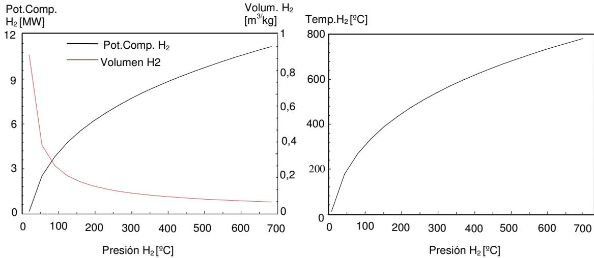
**Fig. 4.7.** Efecto de la variación de la presión del H<sub>2</sub>: (a) Potencia consumida y volumen específico del H<sub>2</sub>; (b) Temperatura a la descarga del compresor.
