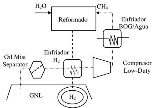
**Fig. 4.8.** Almacenamiento de H<sub>2</sub> enfriado.
