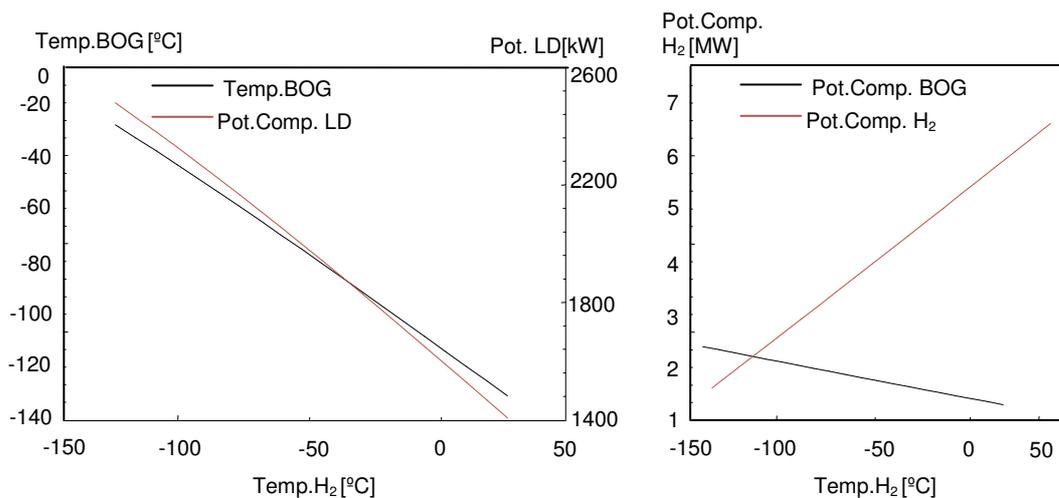
**Fig. 4.12** Efecto de la variación de la temperatura del H<sub>2</sub>. (a) Comparativa de temperatura del BOG, temperatura H<sub>2</sub> y potencia de los LD; (b) Comparativa de temperatura H<sub>2</sub> y potencia de los compresores.
