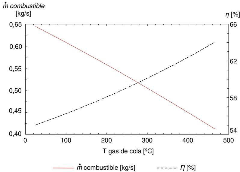
**Fig. 4.4.** Efecto de la variación de la temperatura de los gases de cola para alimentar la combustión.
