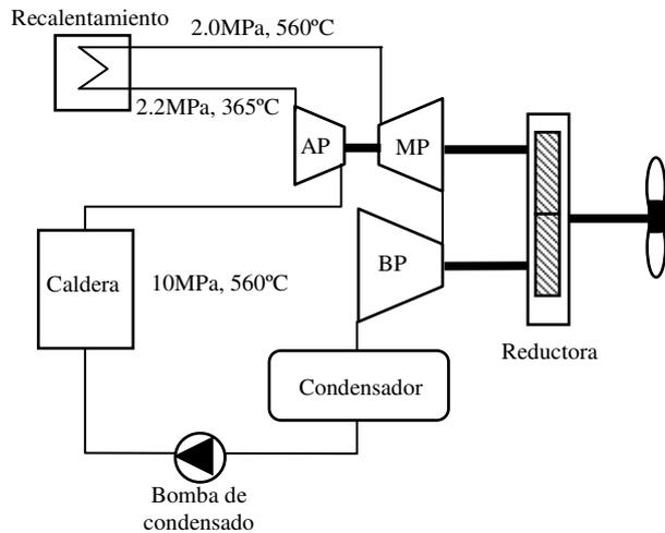
**Fig. 2.5.** Configuración de una planta Ultra Steam Turbine.
