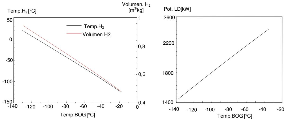
**Fig. 4.9.** Efecto de la variación de la temperatura del H<sub>2</sub>. (a) Temperatura del BOG y volumen de específico del H<sub>2</sub>; (b) Trabajo de los compresores LD.
