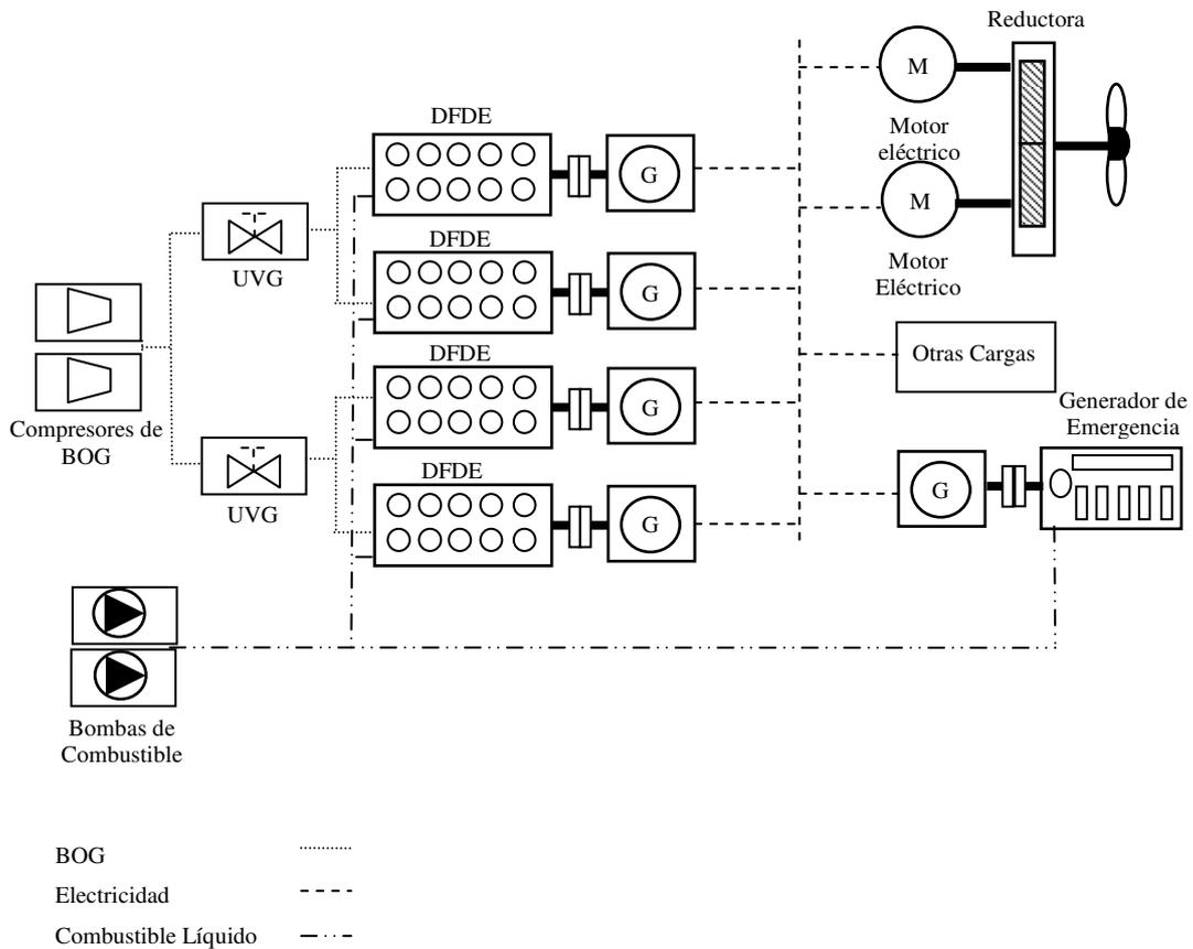
**Fig. 2.14.** Configuración de propulsión diesel-eléctrica mediante motores DF 4T.
