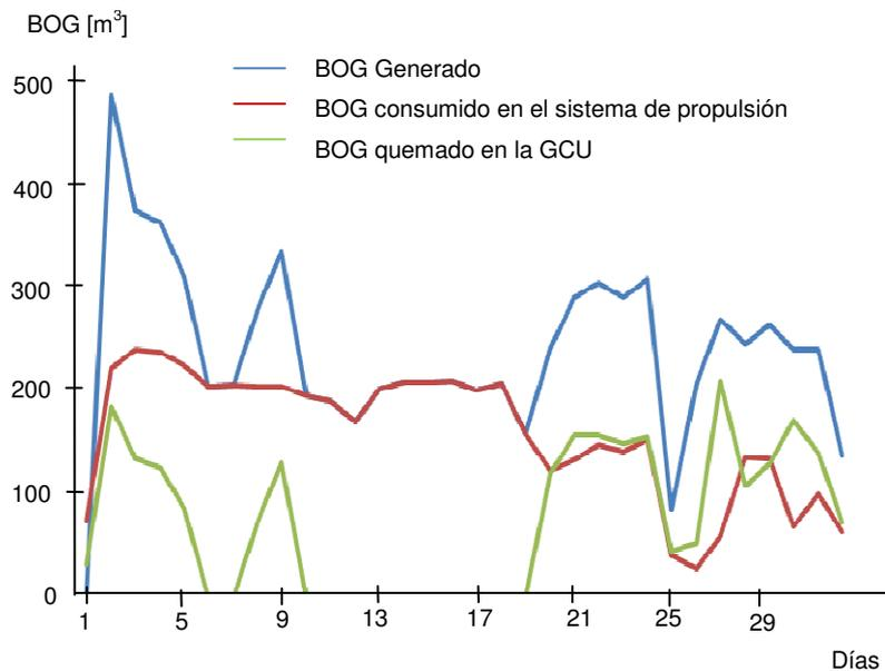
**Fig. 3.4.** Relación BOG generado y el consumido en la planta de propulsión y GCU en condiciones de carga.
