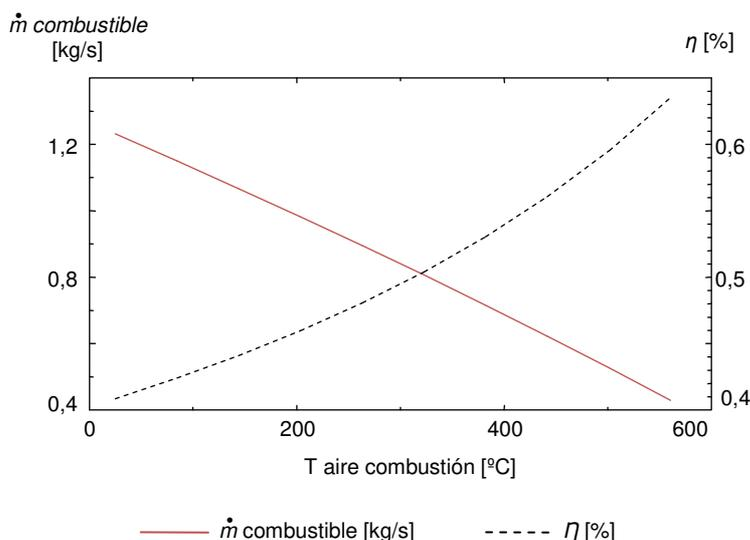
**Fig. 4.2.** Efecto de la variación de la temperatura del aire de combustión.
