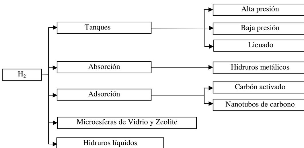
Fig. 3.8. Métodos de almacenamiento de H<sub>2</sub>.
