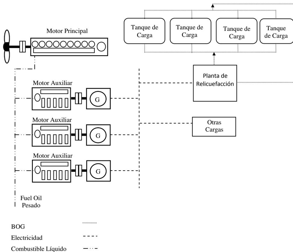
**Fig. 2.12.** Sistema de propulsión con motor principal 2T y planta de relieves.
