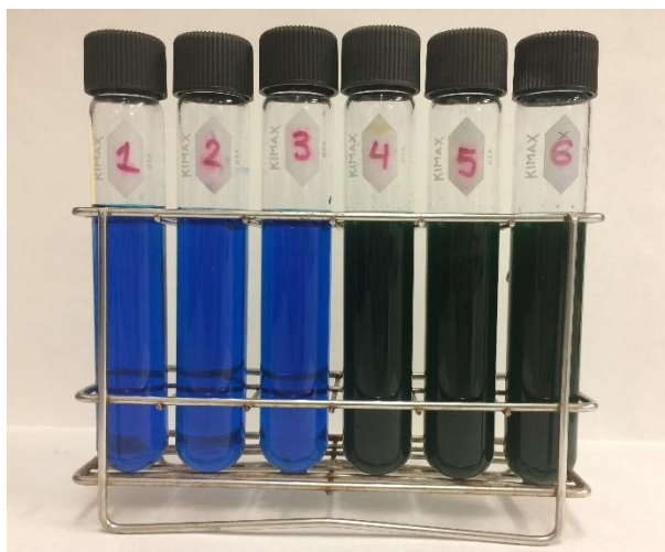
Fig. 3. Deseño das experiencias onde se ven tanto o control (tubos 1 a 3) coma o ensaio coa microalga engadida (tubos 4 a 6) por triplicado.
