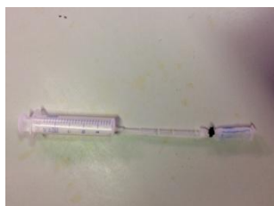
Fig. 16 Instrumento utilizado para la reducción del volumen de agua en el contaje.
