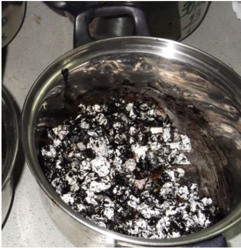
Figura 4. Detalle del AR pretratado (envuelto con un 5% sobre su peso de ECL-2d).
