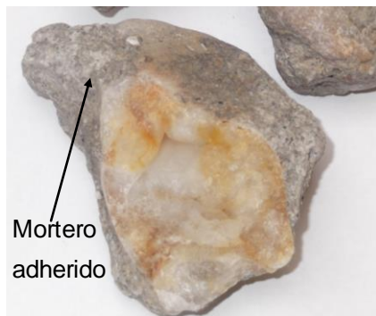
Figura 1. Detalle del mortero adherido a la superficie del AR.
