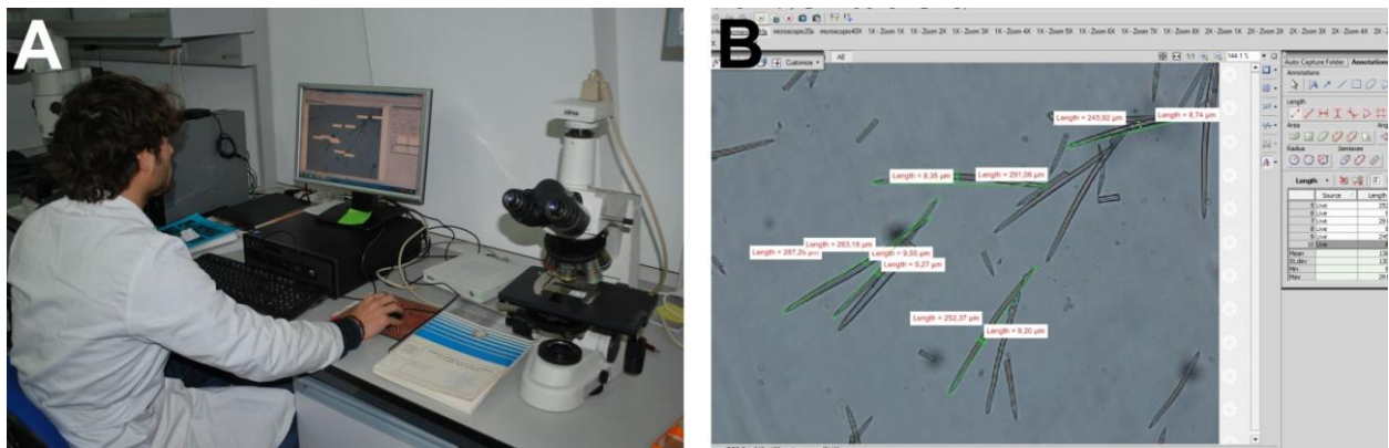
Figura 8. A. Microscopio empleado en la observación de las preparaciones microscópicas. B. Medición de los componentes esqueléticos mediante el programa informático NIS-Elements D.
