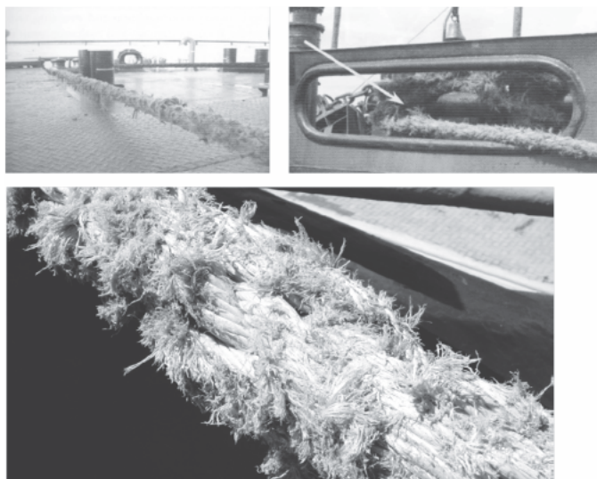
Figura 4. Zona de abrasión estachas. Fonte: VERVLOESEM, W. (2009) Mooring and Anchoring Ships. Vol. 2: Inspection and Maintenance. Londres, Nautical Institute.
