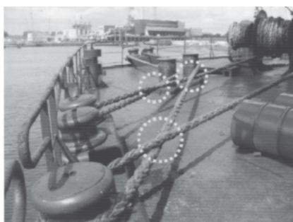
Figura 17. Cruzamento de estachas. Fonte: VERVLOESEM, W. (2009) Mooring and Anchoring Ships. Vol. 2: Inspection and Maintenance . Londres, Nautical Institute.
