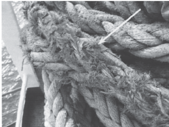
Figura 6. Zona de dano por calor. Fonte: VERVLOESEM, W. (2009) Mooring and Anchoring Ships. Vol. 2: Inspection and Maintenance . Londres, Nautical Institute.
