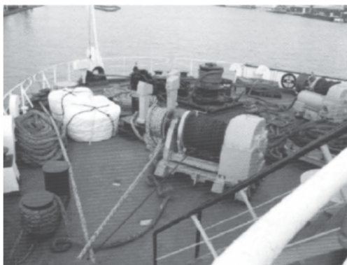
Figura 3. Zona de amarre obstruída por estachas. Fonte: VERVLOESEM, W. (2009) Mooring and Anchoring Ships. Vol. 2: Inspection and Maintenance. Londres, Nautical Institute.
