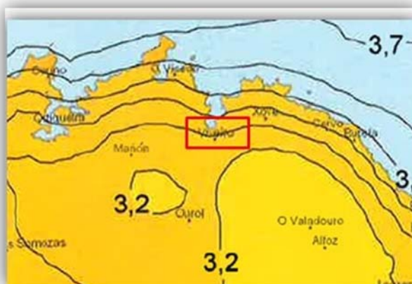
Ilustración 61: Radiación solar global media diaria anual en Viveiro (kWh/m 2 día). Fuente: Atlas de Radiación Solar de Galicia.
