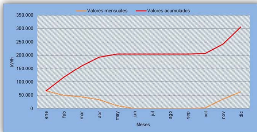
Gráfico 24: Demanda de calefacción en z.c. C1. Edificio en Viveiro Fuente: Elaboración propia.
