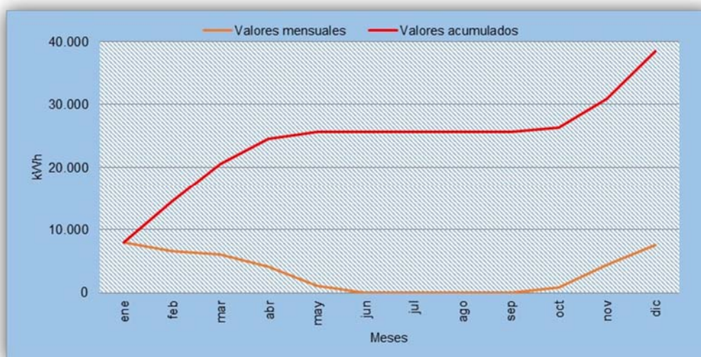
Gráfico 34: Demanda de calefacción en z.c. C1. Edificio en Carballo. Fuente: Elaboración propia a partir de archivos .res del LIDER.
