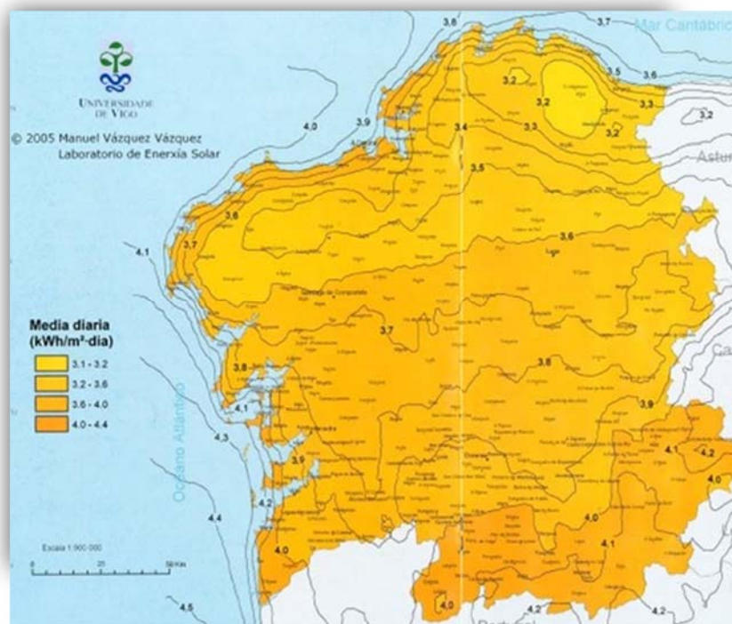
Ilustración 48: Radiación solar global media diaria anual (kWh/m 2 día). Fuente: ATLAS DE RADIACIÓN SOLAR DE GALICIA.
