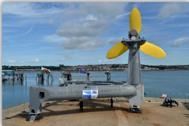
Ilustración 40: Turbina de eje horizontal. Fuente: http://www.tidalenergytld.com/
