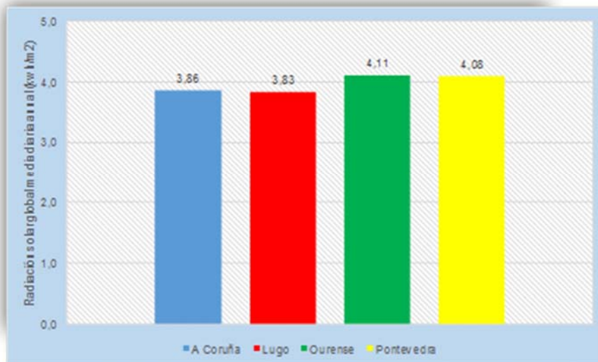
Gráfico 22: Radiación solar global media diaria anual en las capitales de provincia. Fuente: Atlas de Radiación Solar en España utilizando datos del SAF de Clima de EUMESAT.
