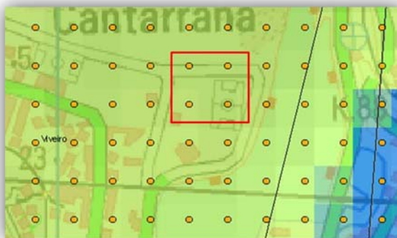
Ilustración 92: Puntos de datos de viento. Edificio en Viveiro Fuente: Elaboración propia a partir del Atlas Eólico del IDAE.
