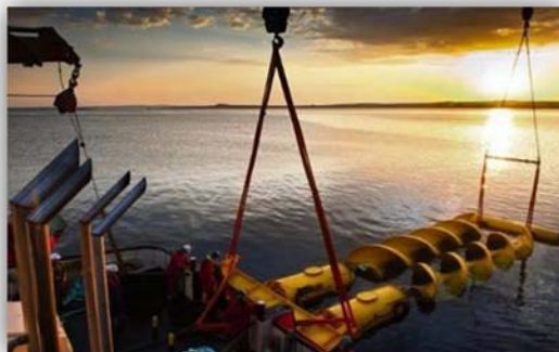
Ilustración 41: Dispositivo Tornillo Helicoidal. Fuente: Ocean Energy: State of the Art.
