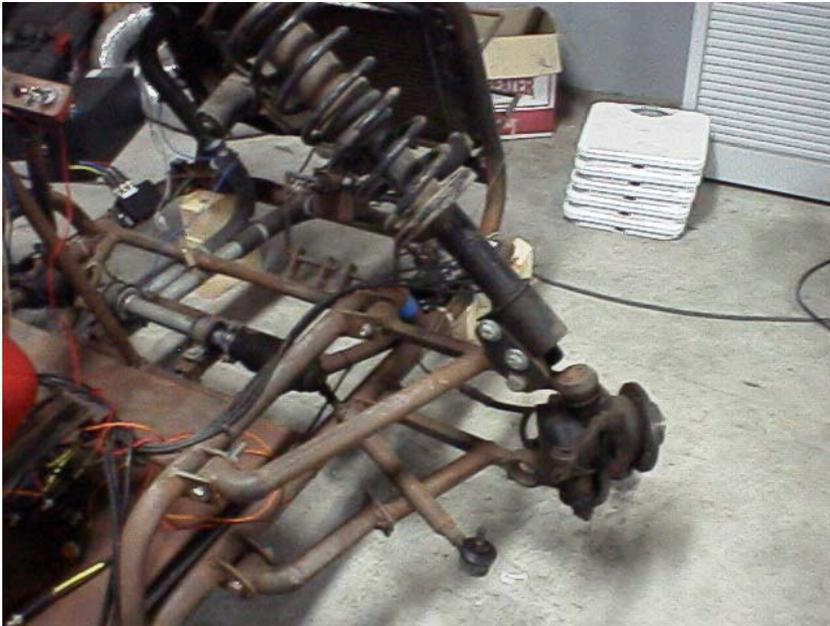
**Figura 2.3 Sistema de suspensión delantero.**
