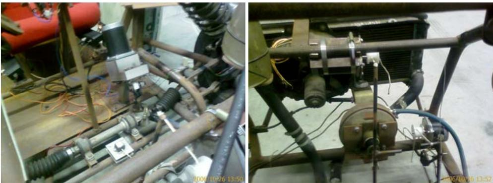
**Figura 8.4 Instalación de los actuadores en el vehículo.**
