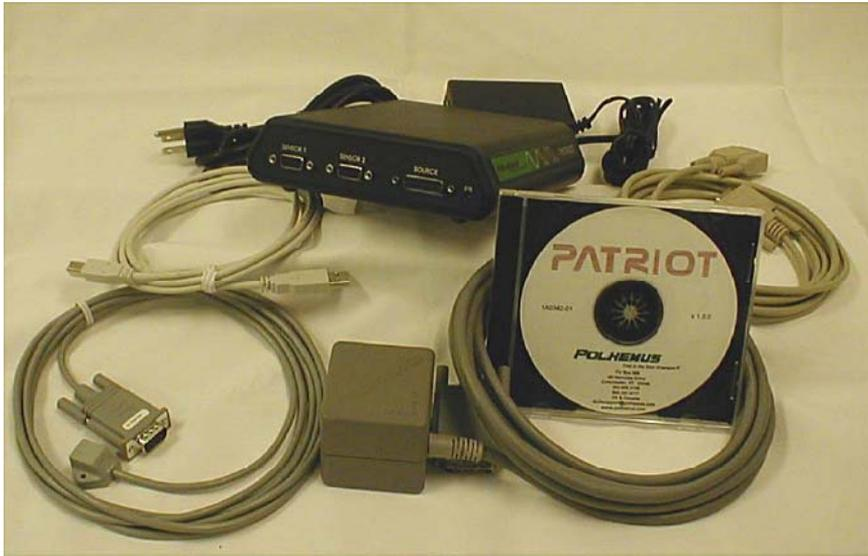
**Figura 4.16 Equipo completo de sensor, unidad central y generador de campo.**
