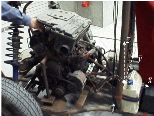
**Figura 2.4 Sistema de ejes local del grupo motor.**
