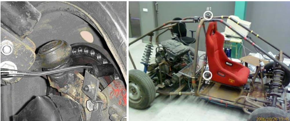
Figura 8.2 Colocación de los sensores en el vehículo.
