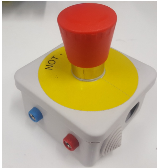
Imagen 12: Seta de Emergencia
